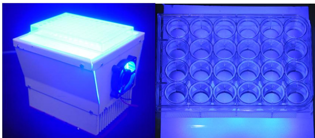
FIGURA 5 – Placa de 24 compartimentos posicionada sobre a superfície de iluminação da “Bio Table” azul acionada.
