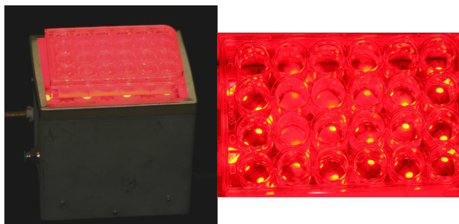
FIGURA 6 - Placa de 24 compartimentos posicionada sobre a superfície de iluminação da “Bio Table” vermelha acionada.
