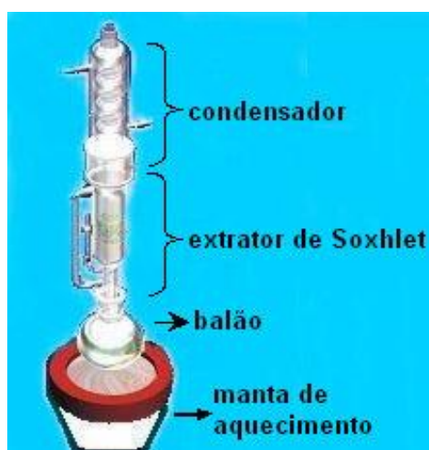
Figura 2 - Esquema do extrator de Soxhlet utilizado na extração do óleo de sementes de girassol
