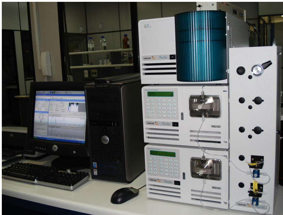
Figura 6 – Cromatógrafo líquido utilizado nas análises de vitamina E ( \alpha -tocoferol), do óleo de girassol
