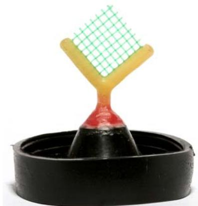
FIGURA 3 – PADRÃO DE FUNDIÇÃO PARA TESTE DE FLUIDEZ.
