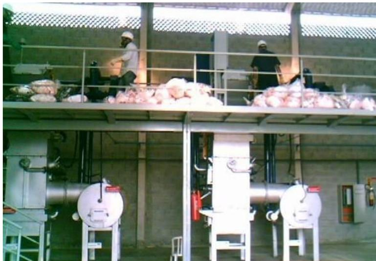
Figura 35 - Vista do carregamento do incinerador
