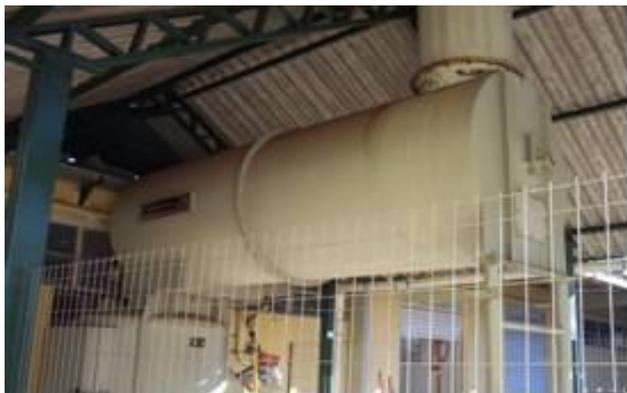
Figura 51 – Detalhe do forno crematório
