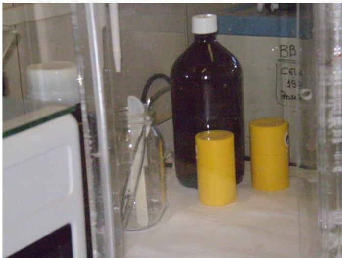
Figura 36 - Resíduo radioativo armazenado no laboratório, acondicionado em embalagem de chumbo (amarelo)
