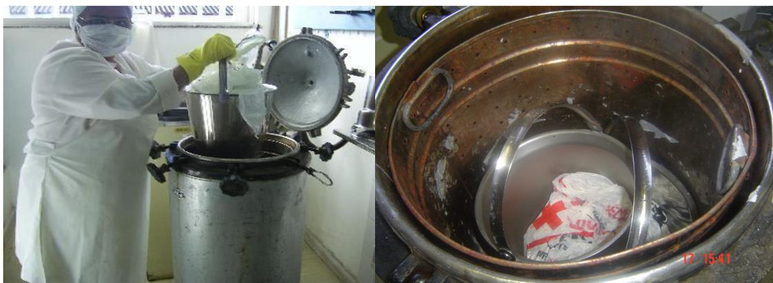
Figura 49 – Tratamento interno de resíduos infectantes em autoclave
