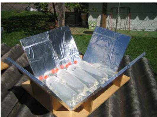
**Figura 3.3** - Concentrador solar com capacidade para 4 garrafas de PET
