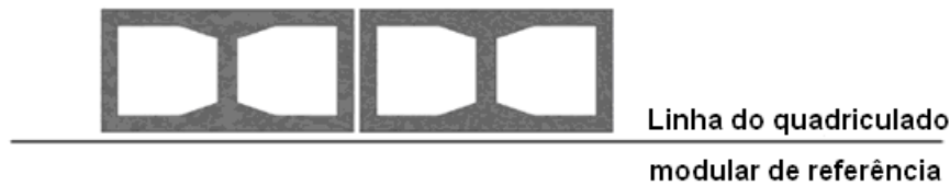
Ilustração 2.25 – Componentes em posição lateral em relação à linha do reticulado modular de referência. Fonte: Greven e Baldauf, 2007
