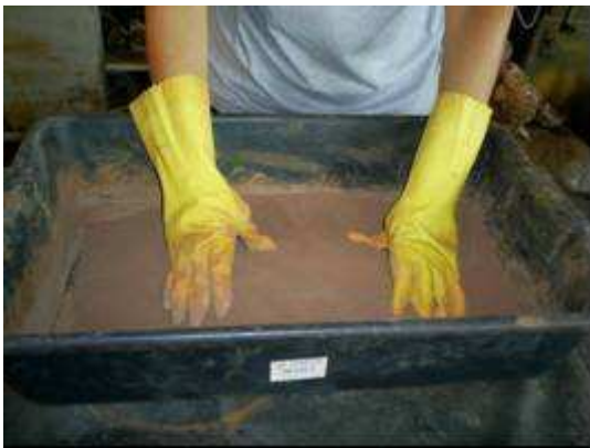
Ilustração 3.9- Homogeneização da mistura seca.
