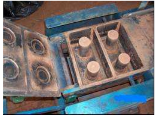
Ilustração 3.4 – Prensa manual empregada.
