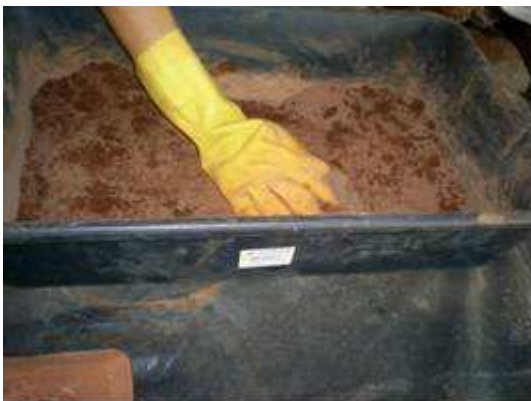
Ilustração 3.11- Homogeneização da mistura
