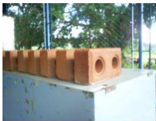
Ilustração 2.22- Tijolos modulares (dimensões 25,0 x 12,5 x 6,25 cm).
