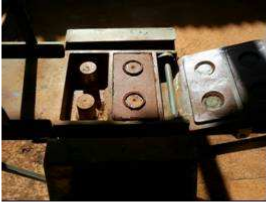
Ilustração 3.13- Prensagem do material
