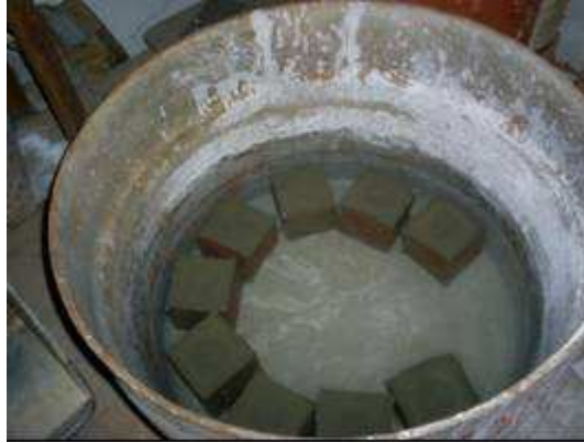
Ilustração 3.18- Prismas submersos na água para ensaio de resistência a compressão simples
