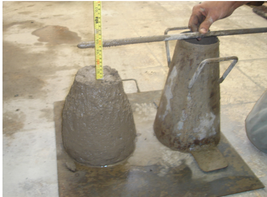
Foto 6.2 – Slump – traço 1:3,5 – 10% RBMG
