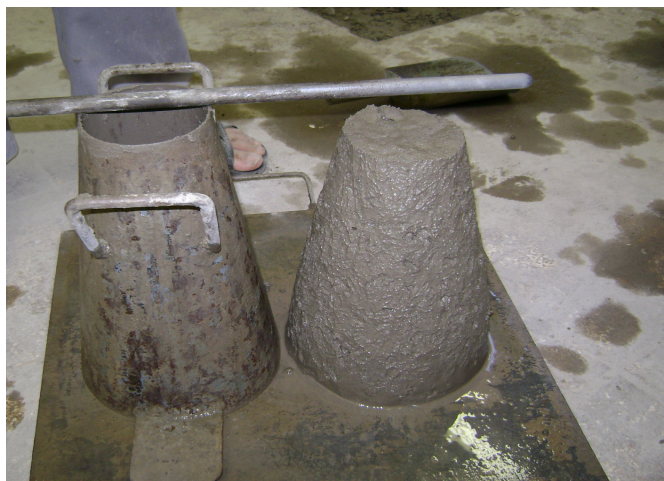
Foto 6.4 – Slump – traço 1:3,5 – 20% RBMG
