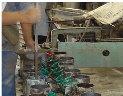
Foto 5.4 – Moldagem e adensamento dos corpos-de-prova
