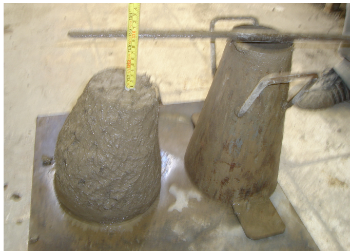
Foto 6.3 – Slump – traço 1:3,5 – 15% RBMG
