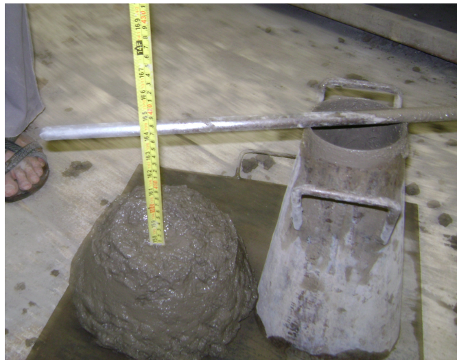
Foto 6.12 – Slump – traço 1:6,5 – 20% RBMG
