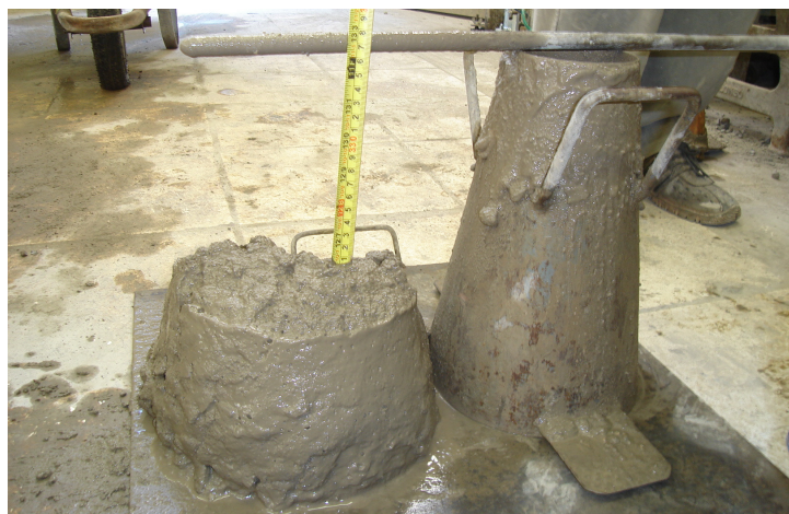
Foto 6.10 – Slump – traço 1:6,5 – 10% RBMG
