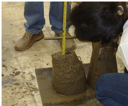
Foto 6.1 – Slump – traço 1:3,5 – 5% RBMG
