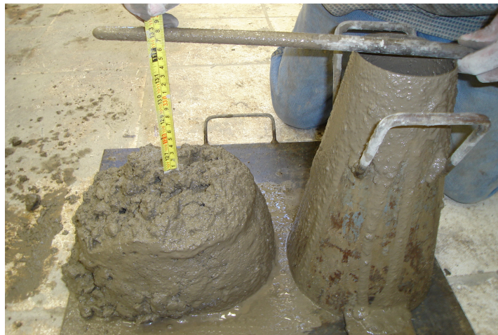
Foto 6.9 – Slump – traço 1:6,5 – 5% RBMG
