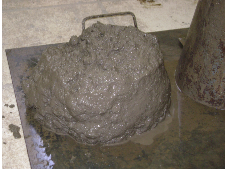
Foto 6.11 – Slump – traço 1:6,5 – 15% RBMG
