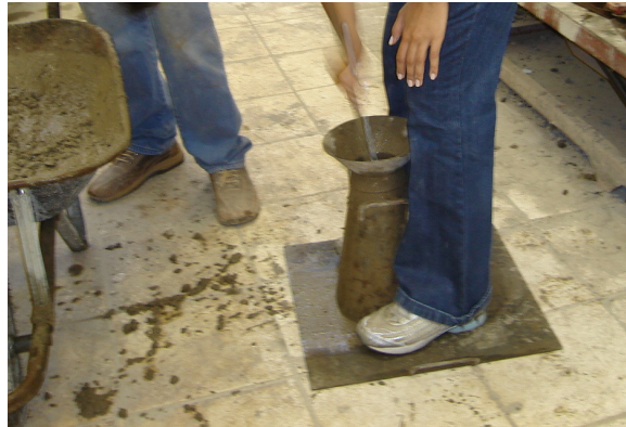
Foto 5.6 – Ensaio de abatimento de tronco de cone - moldagem
