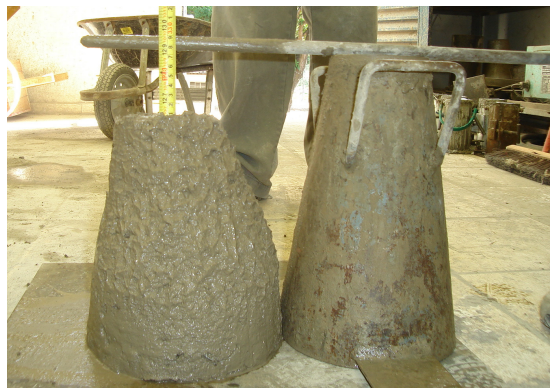
Foto 5.7 – Ensaio de abatimento de tronco de cone - desmoldagem
