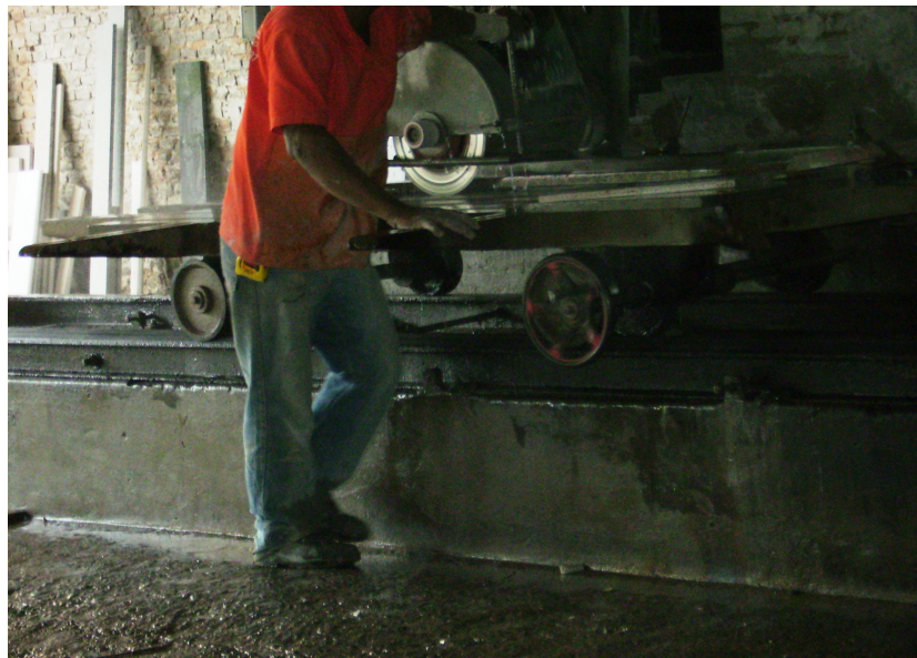
Figura 2.1 – Corte de chapas de granito e mármore
