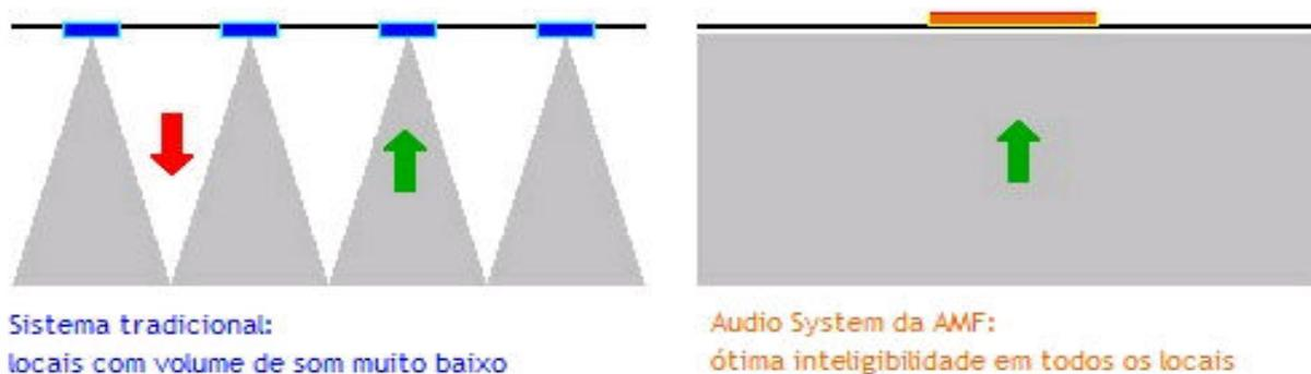
**Figura 61.** Sistema Tradicional e Sistema Áudio System da AMF
