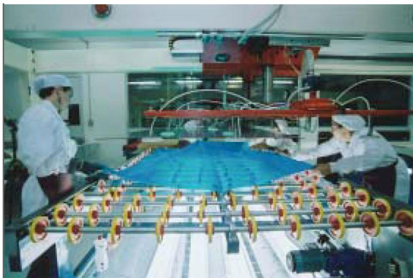
**Figura 55.** Sistema de aplicação de PVB nos vidros
