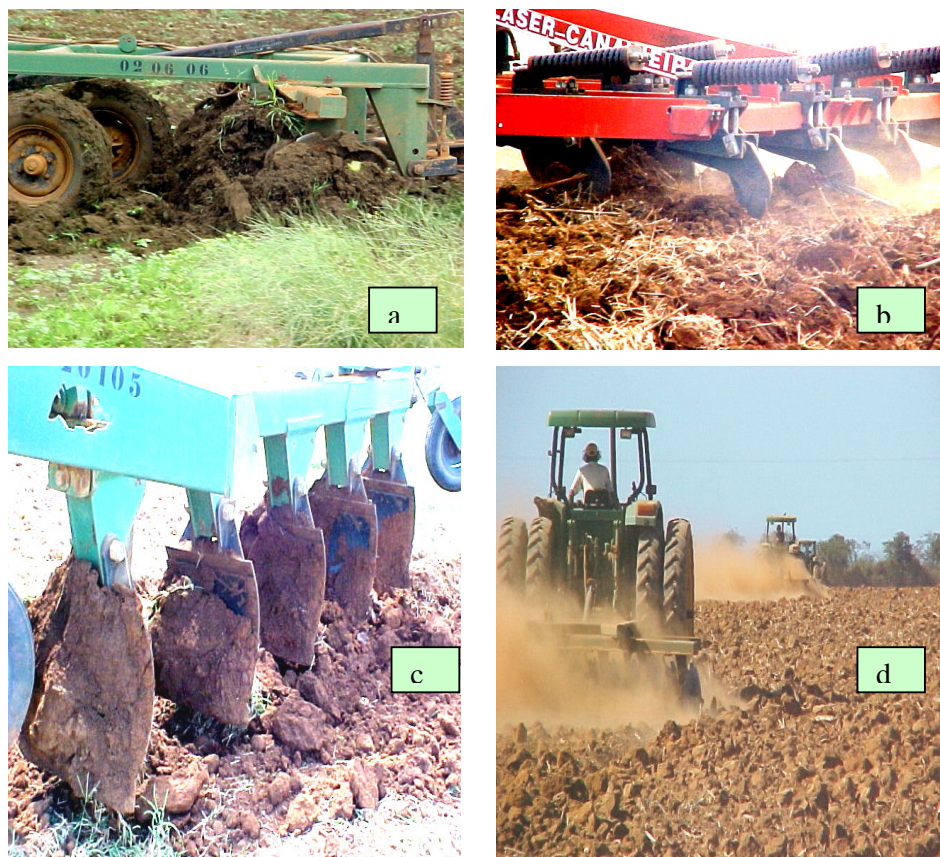
Figura 2 - Preparo do solo do lote experimental. a) controle da erva daninha; b) subsolagem; c) arado de aiveca revirando o solo; d) passagem de grade de disco para triturar o solo.
