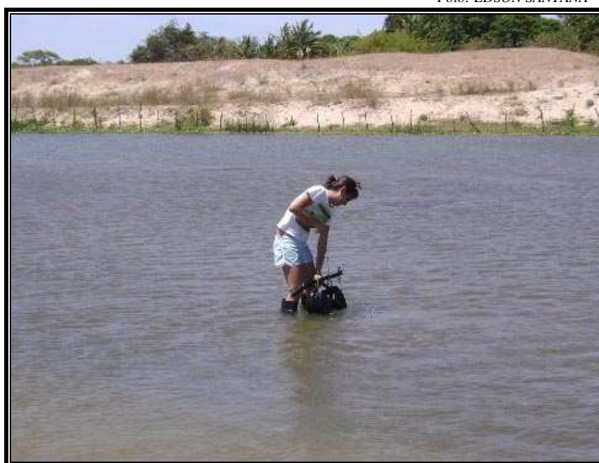
Figura 08 – Coleta da macrofauna bentônica com coletor tipo Draga de Van Veen .
