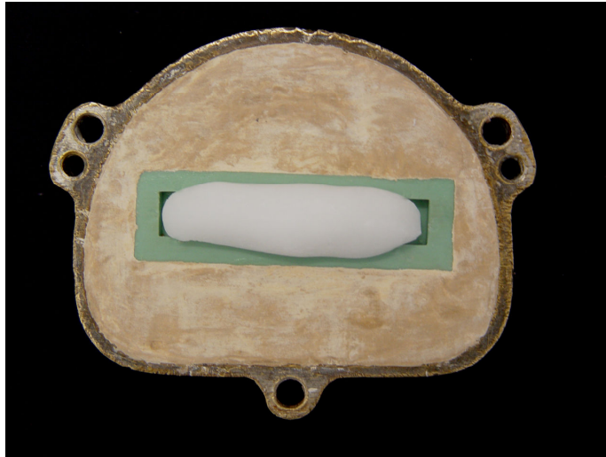
FIGURA 9- Mistura da resina acrílica na fase plástica colocada no interior do molde em silicone.
