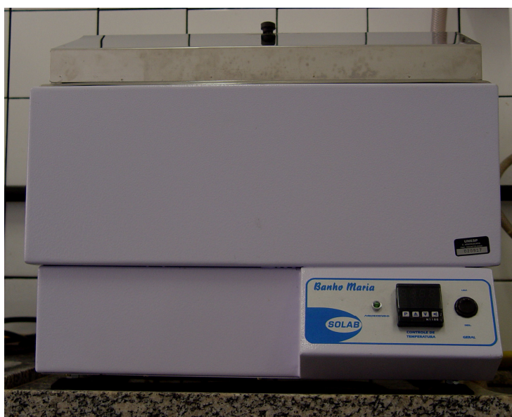
FIGURA 4 - Termopolimerizadora automática utilizada para polimerização da resina acrílica.
