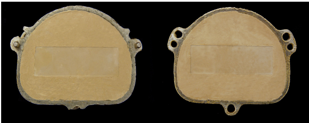
FIGURA 1- Lâminas de vidro incluídas em mufla metálica.
