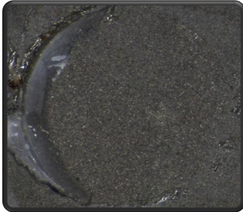
FIGURA 9. Superfície do Ti cp jateada com  $\text{Al}_2\text{O}_3$  de  $50\ \mu\text{m}$  e Rocatec após o ensaio de cisalhamento
