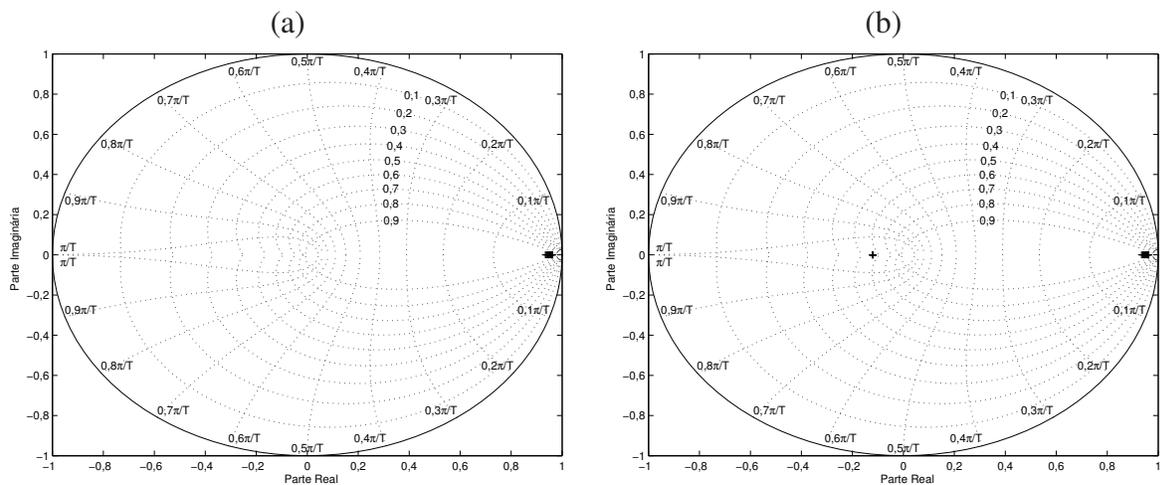
Figura 5.3: Autovalores de modelos neurais NARMAX utilizando massa de dados  $dad\_ctv1$ . (a) Modelo neural com  $n_y = 1$ , todos os autovalores encontram-se no semicírculo direito do plano  $z$  (b) Modelo neural com  $n_y = 2$ , possui 1 autovalor no semicírculo esquerdo do plano  $z$
