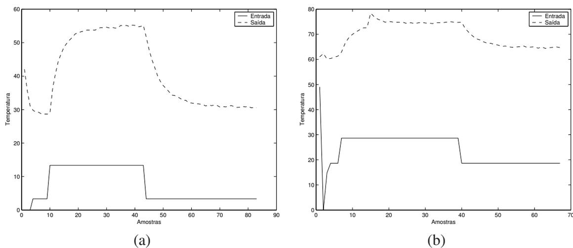
Figura 5.9: Resposta ao degrau de um Processo Térmico. Eixo- $x$  são as amostras. Linha contínua é a entrada e a tracejada é a temperatura de saída, ambos normalizados de 0 a 100%. (a) Massa de dados  $fd1$  e (b) massa de dados  $fd2$
