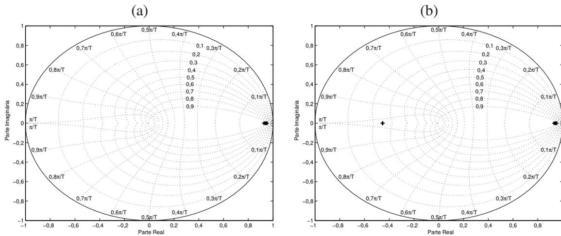
Figura 5.4: Autovalores de modelos neurais NARMAX utilizando massa de dados *dad\_ctv2*. (a) Modelo neural com  $n_y = 1$ , todos os autovalores encontram-se no semicírculo direito do plano  $z$  (b) Modelo neural com  $n_y = 2$ , possui 1 autovalor no semicírculo esquerdo do plano  $z$
