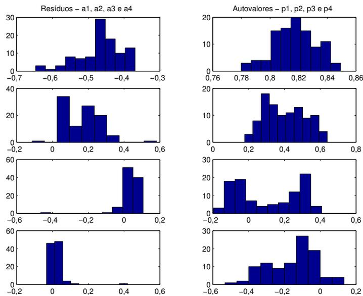
Figura 3.5: Autovalores e Resíduos para o modelo (3.7) com SNR igual à 50 e ordem igual a 4, sendo  $p_3$  e  $p_4$  o autovalor sobredimensionado. O eixo das ordenadas representa a quantidade de realizações e o eixo das abcissas representa a faixa de histograma do autovalor ou resíduo do modelo estimado.
