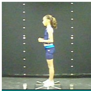
Figura 3.14 – Posição de retorno à plataforma do protocolo de medição sobre a plataforma de força.
