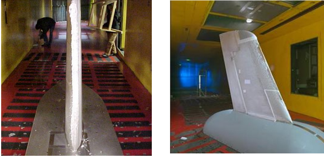
Figura 4.1 – Fotografias ilustrando a secção de testes do túnel de gelo da IRT/NASA.
