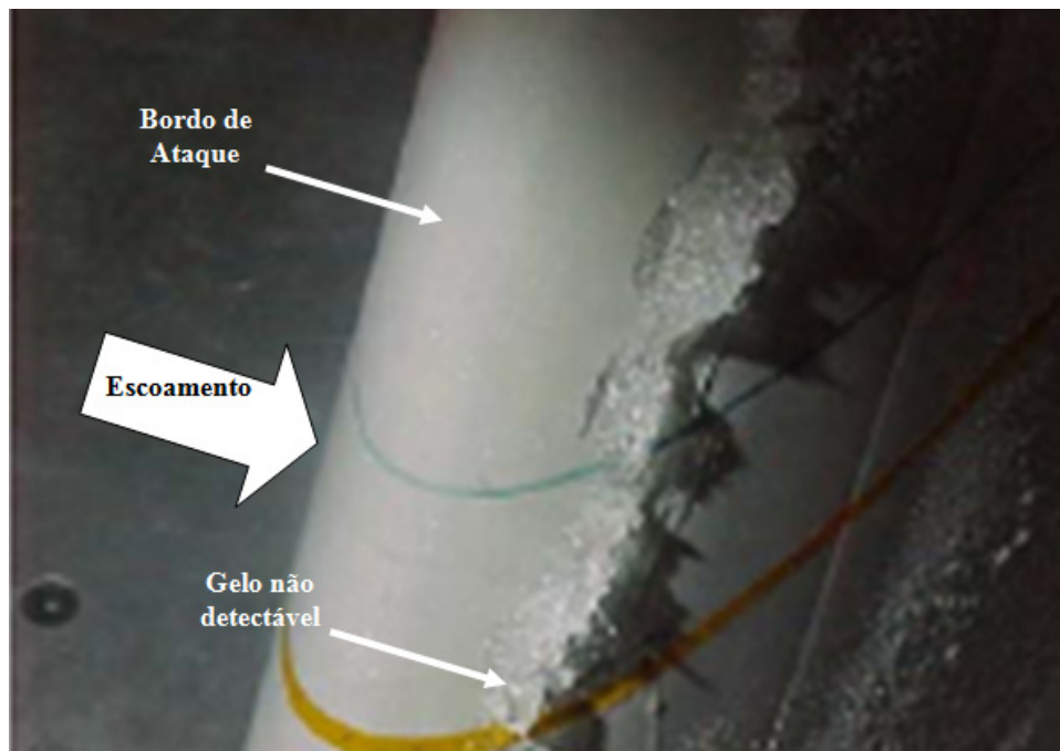
Figura 4.4 – Detalhe do resultado do ensaio feito em túnel de gelo mostrando a formação de gelo não-detectável.
