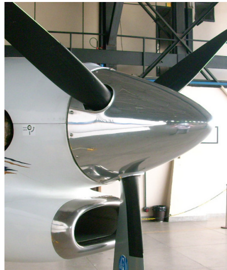
Figura 3.3 - Hélice com sistema de proteção contra gelo por aquecimento elétrico.
