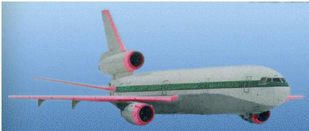
Figura 3.1 - Superfícies de um avião, protegidas pelo sistema de ar quente.
