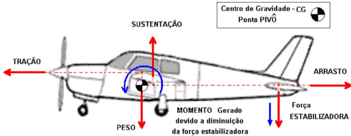
Figura 2.8 - Esquema de forças e momentos em uma aeronave.
