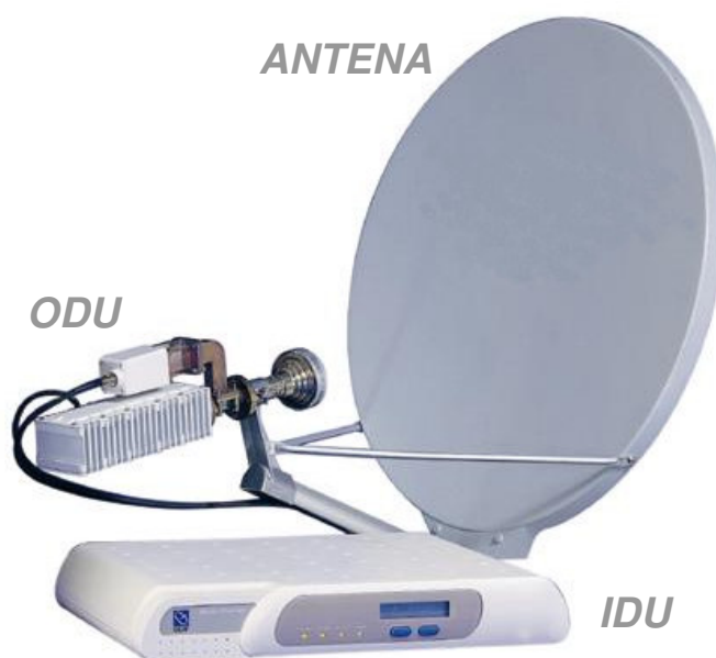
Figura II.12 - Componentes de um terminal VSAT
