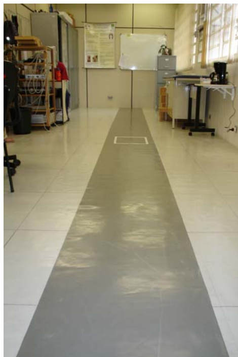
Figura 5 – Imagem da disposição da passarela e da plataforma de força no Laboratório onde foram realizadas as coletas de dados.
