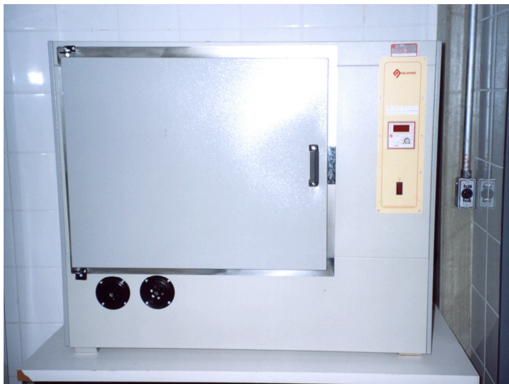
FIGURA 6 - Estufa especial para secagem de plantas
