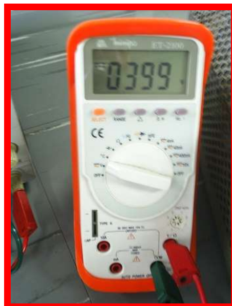
Figura 4.36. Valor da tensão de saída em operação como retificador PFC pré-regulador para correção do fator de potência
