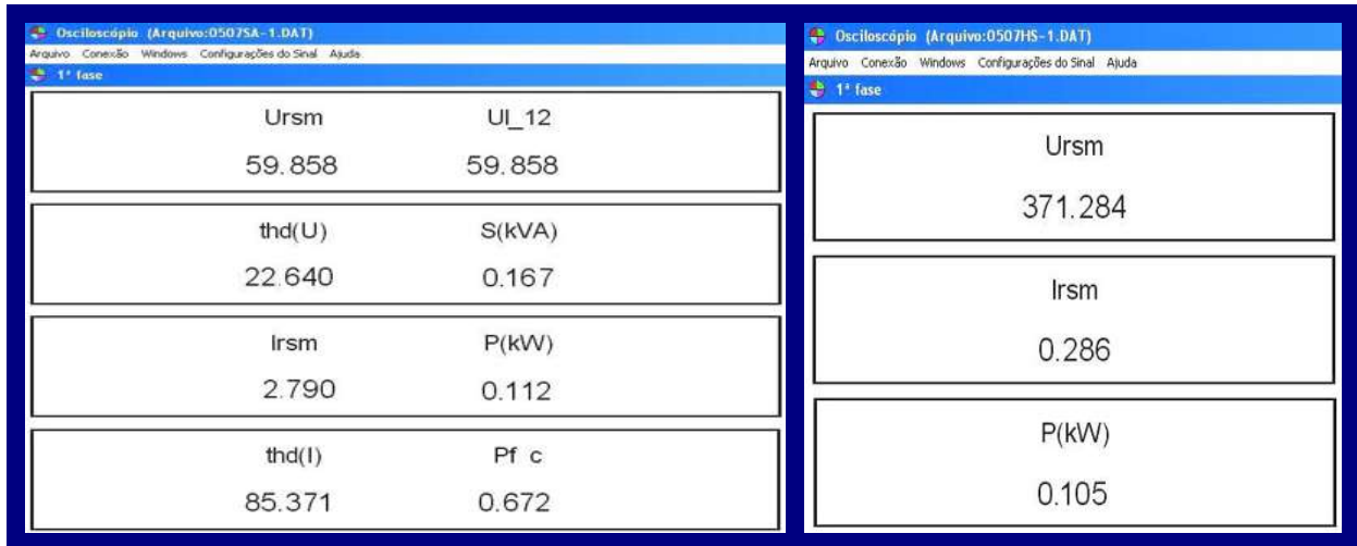
Figura 4.72. Grandezas medidas na entrada e na saída do conversor_ operação em SAG_ Vin= 60Vca e Vout= 371Vcc
