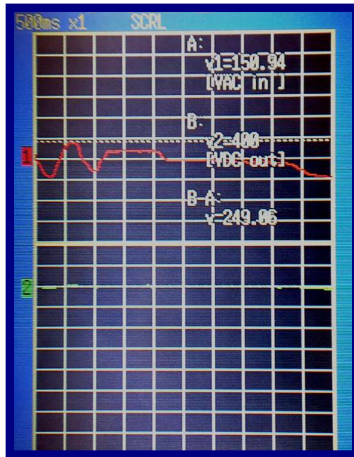
Figura 4.81 CH1 _Tensão de entrada, CH2 _Tensão de saída. Comportamento da tensão de entrada e da tensão de saída – Pré-afundamento
