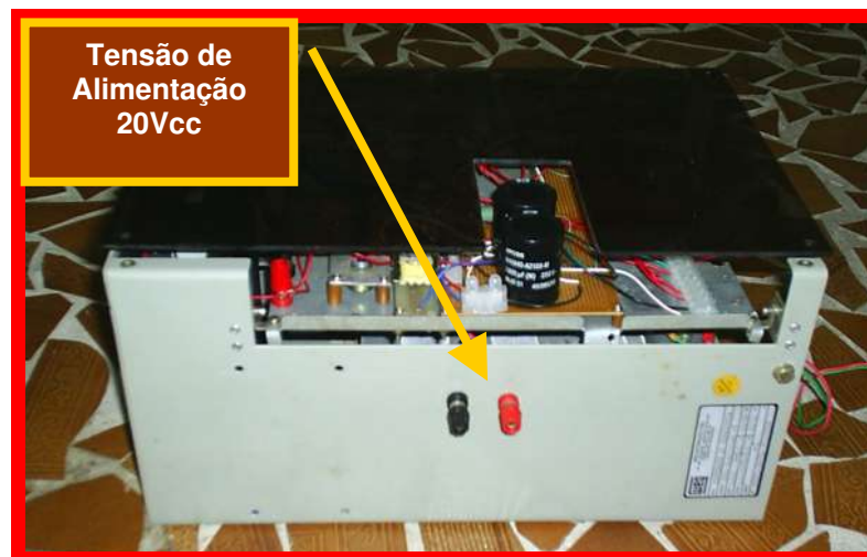
Figura 4.26b. Vista traseira do protótipo montado contendo bornes para alimentação do circuito de controle
