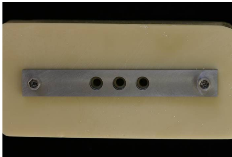
Figura 8 – Componente 3 conectado à superfície do bloco de poliuretano com as perfurações realizadas.
