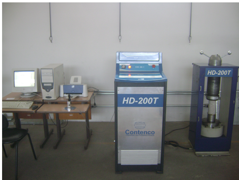
Figura 3.12 – Equipamentos utilizados nos ensaios do concreto endurecido
