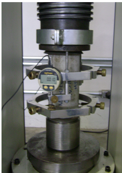
Figura 3.13 – Equipamento utilizado no ensaio de módulo de deformação.
