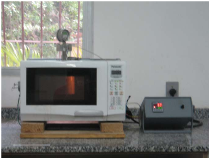
Figura 3.2. Microondas hidrotermal adaptado a partir de um microondas doméstico e seu reator.
