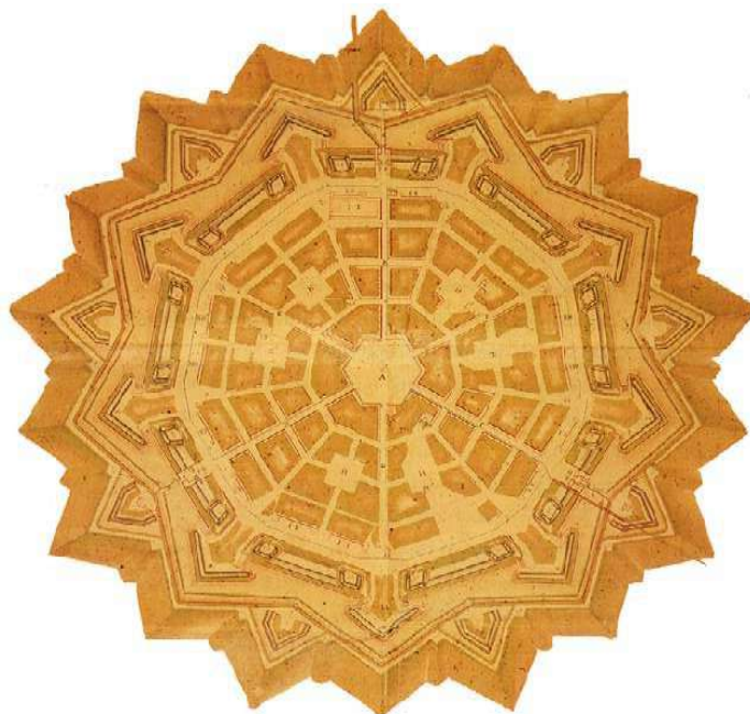
Fig. 3.32: Pianta di Palmanova (século XVII – Museo Correr de Veneza) onde é possível verificar todo o seu sistema defensivo, baseado nas teorias geométricas e pirobalísticas desenvolvidas desde o final do século XV.
