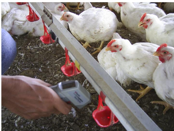
Figura 9. Termômetro infravermelho (Raytec)
