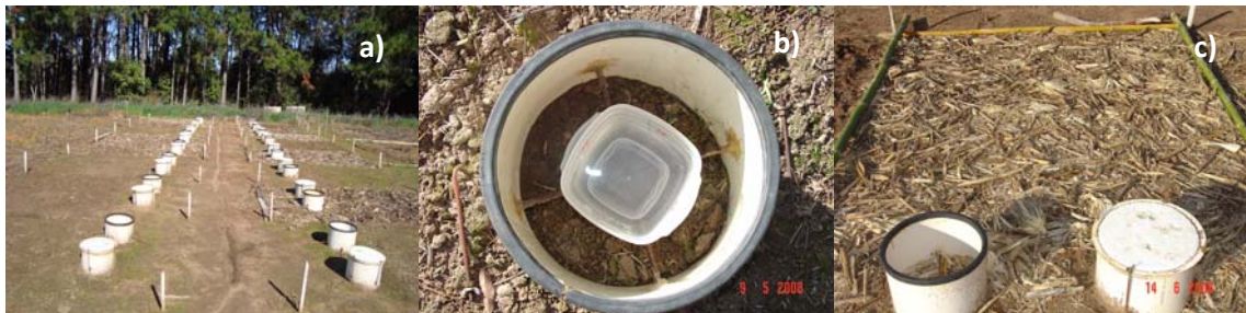
Figura 13 – a) visão geral do experimento; b) detalhe do sistema de coleta do CO 2 , mostrando o recipiente com NaOH no interior da câmara e c) duas câmaras de cada repetição de um dos tratamentos. Santa Maria, 2009. Denega, 2008.
