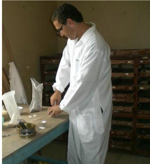
Figura 11. Detalhe da trituração das amostras em almofariz de porcelana
