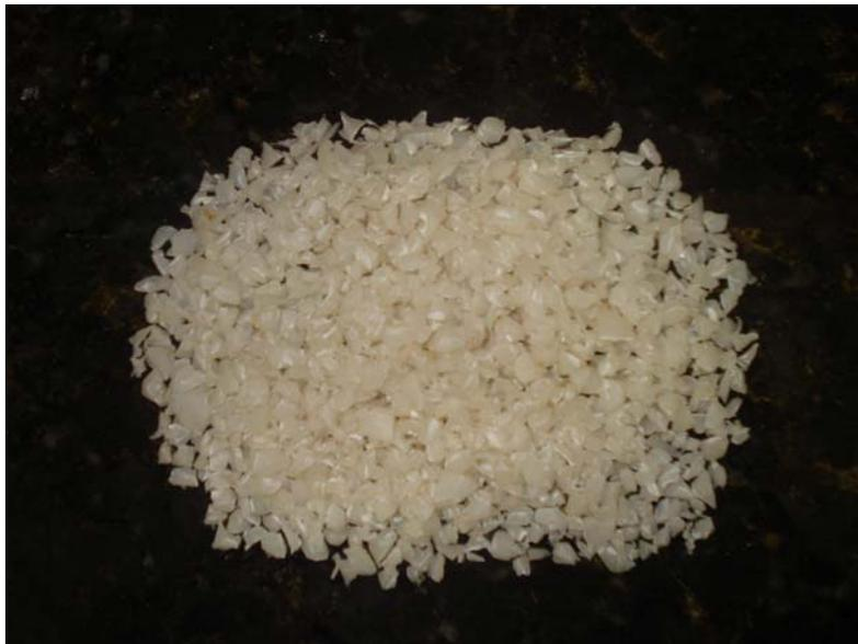
Figura 11: HDPE extrusado e moído para utilização em injetora.
