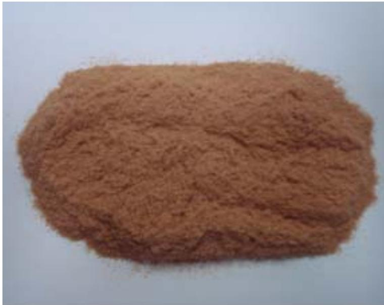
Figura 7: Amostra de farinha de cedro utilizada nos compósitos WPC
