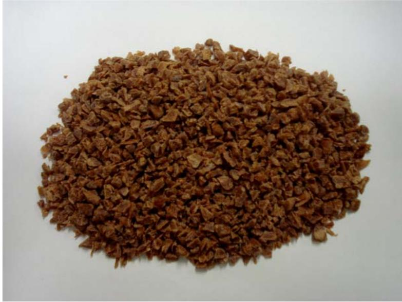
Figura 10: WPC extrusado e moído para utilização em injetora.
