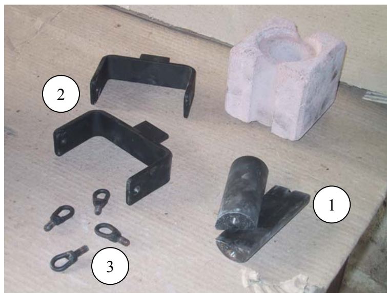
FIGURA 54 – Dispositivos utilizados para o ensaio de tração direta no TJ 111
