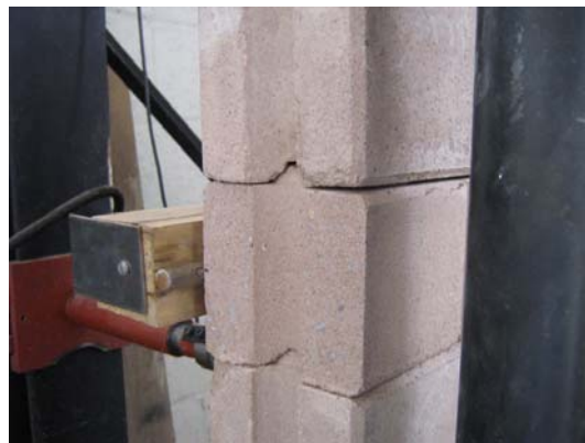
(b) abertura da junta, fora da região de flexão pura
