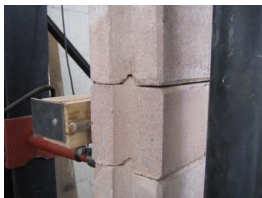
(f) ruptura fora das linhas de carregamento
