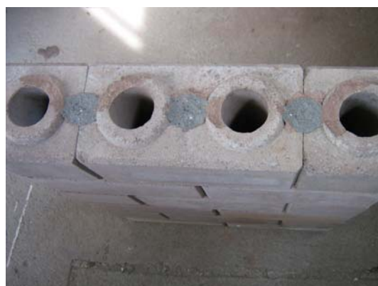
(d) ruptura do cilindro de argamassa
