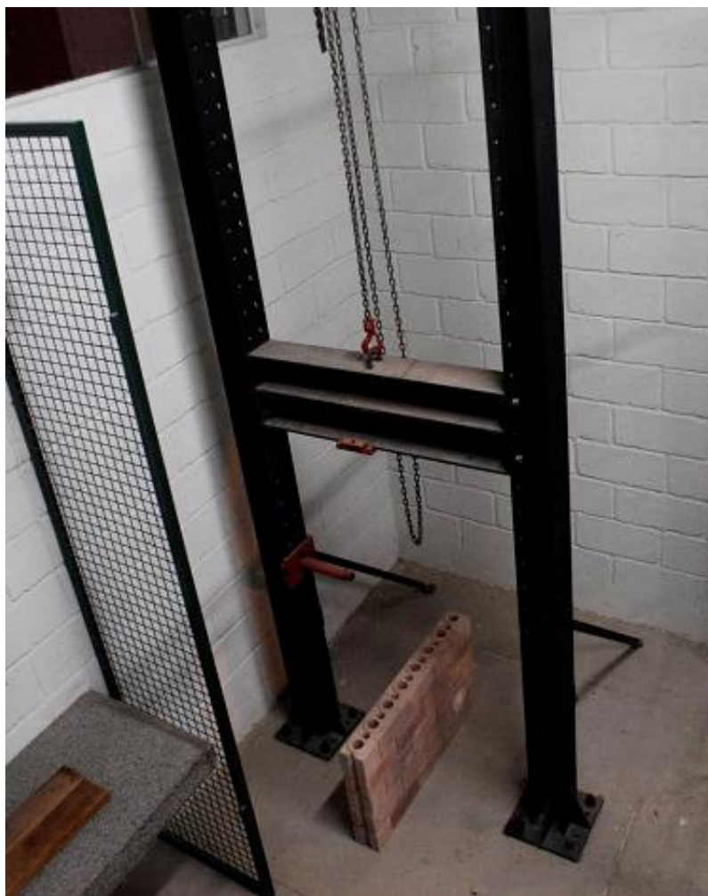
FIGURA 72 – Vista panorâmica do pórtico utilizado para o ensaio das paredes
