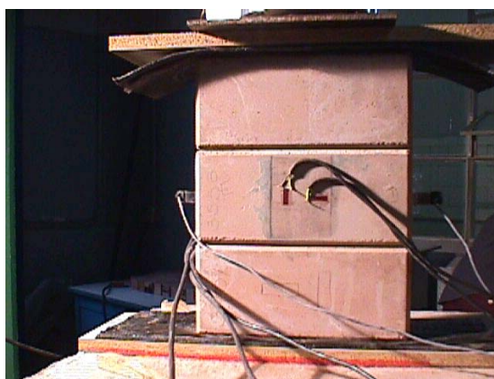
FIGURA 70 – Bloco TJ 110 pronto para o ensaio de compressão e conectado ao SAD
