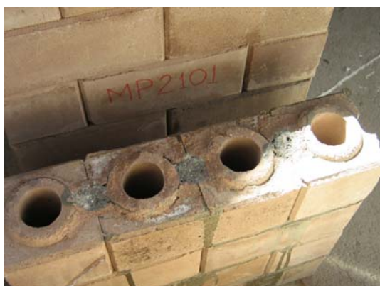
(c) ruptura do cilindro de argamassa
