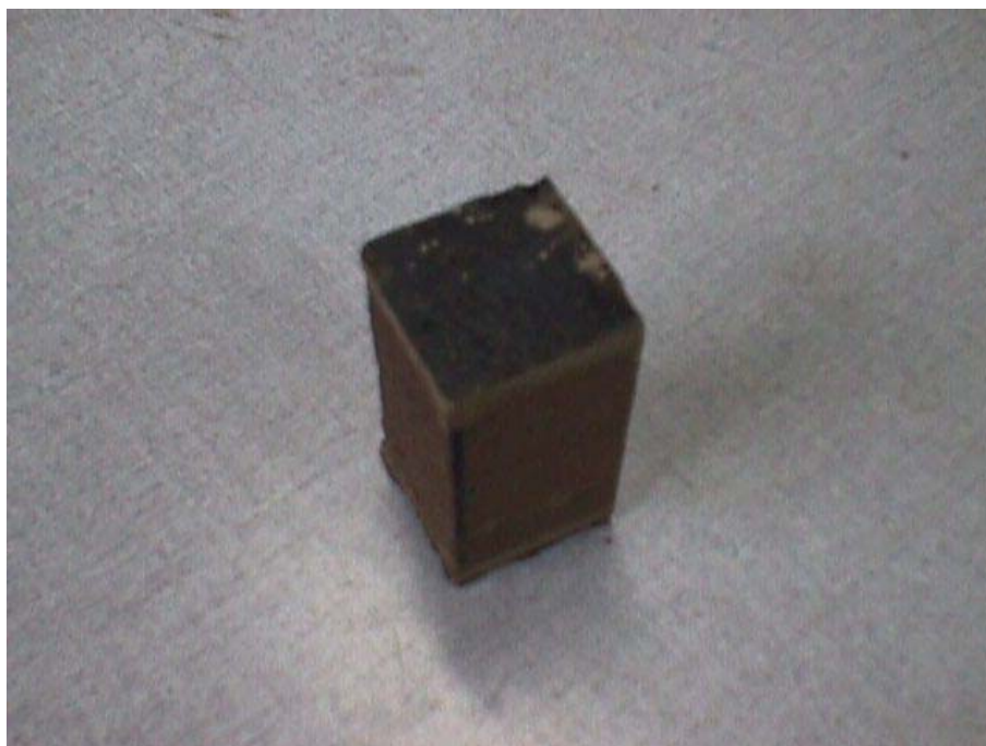
FIGURA 51 – Corpo-de-prova capeado com enxofre - PBR
