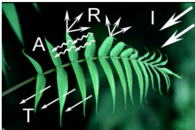
Figura 2. Processo de interação da radiação eletromagnética com uma folha. I- energia incidente; R- energia refletida; A- energia absorvida e T- energia transmitida. Fonte: CCRS (1999).
