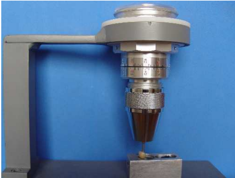
Fig 3. Dispositivo para posicionamento do corpo-de-prova e medidor analógico de torque para aplicação do torque de inserção e mensuração do destorque.
