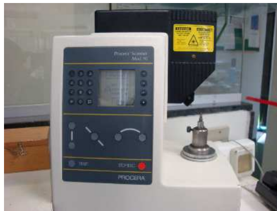
Figura 15. Equipamento para scaneamento (Procera Scanner Mod 50) de infra-estrutura metálica a fim de reproduzir as dimensões das infra-estruturas do grupo V.
