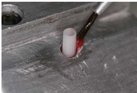
Figura 3. Aplicação de resina acrílica autopolimerizável sobre padrão para fundição posicionado na matriz metálica.
