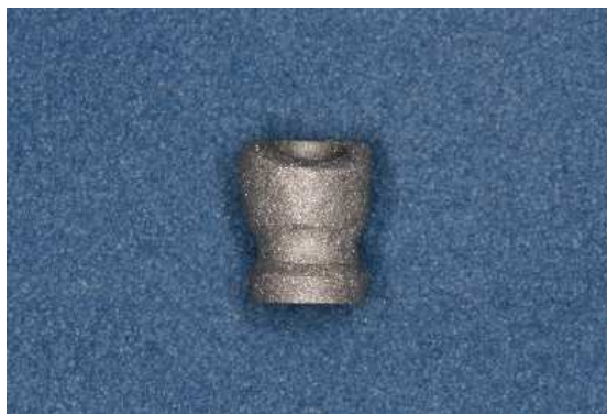
Figura 11. Pilar do tipo UCLA fundido em titânio puro grau 2 após jateamento com óxido de alumínio.
