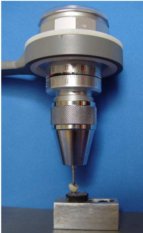
Fig. 1. Medidor analógico de torque e corpo-de-prova posicionados para aplicação do torque de inserção e mensuração de destorque.
