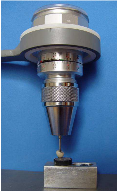
Fig. 2. Medidor analógico de torque e corpo-de-prova posicionados em um dispositivo para aplicação do torque de inserção e mensuração de destorque.
