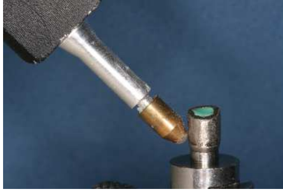
Figura 16. Scaneamento de infra-estrutura metálica no Procera Scanner Mod 50.
