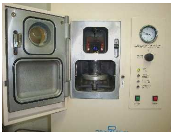
Figura 10. Equipamento para fundição em titânio (Rematitan autocast) de pilar do tipo UCLA dos grupos III e IV.
