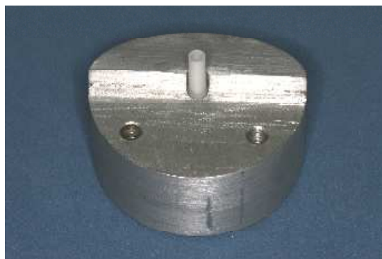
Figura 2. Matriz metálica para padronização da aplicação de resina acrílica autopolimerizável aos padrões para fundição dos grupos I, II, III e IV.
