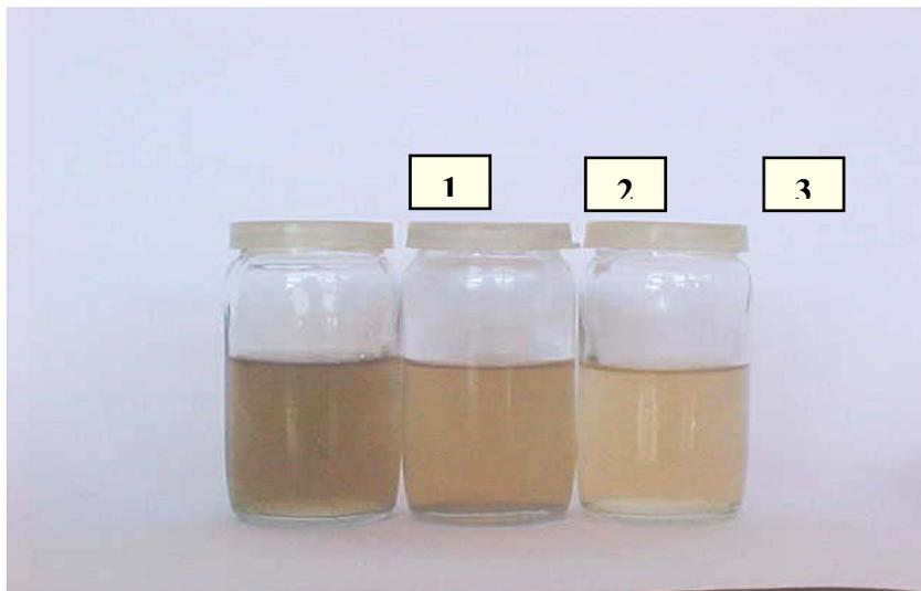
**Figura 4.25:** Fotografia dos líquidos percolados utilizados no 4º Planejamento experimental, (1) Chorume Bruto, (2) Experimento 60 e (3) Experimento 61.
