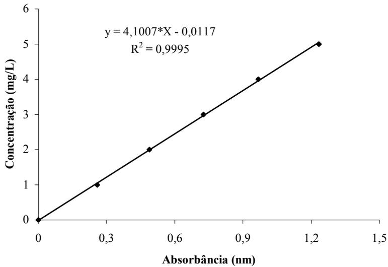
**Figura A5** – Curva de calibração para determinação de Nitrogênio Amoniacal.
