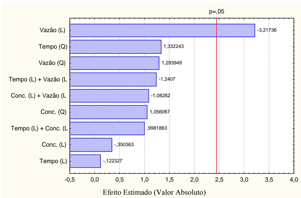
**Figura 4.15:** Diagrama de Pareto para todas as variáveis e suas possíveis interações, em relação à remoção de DQO, a um nível de significância de 95%, para o 2º planejamento.
