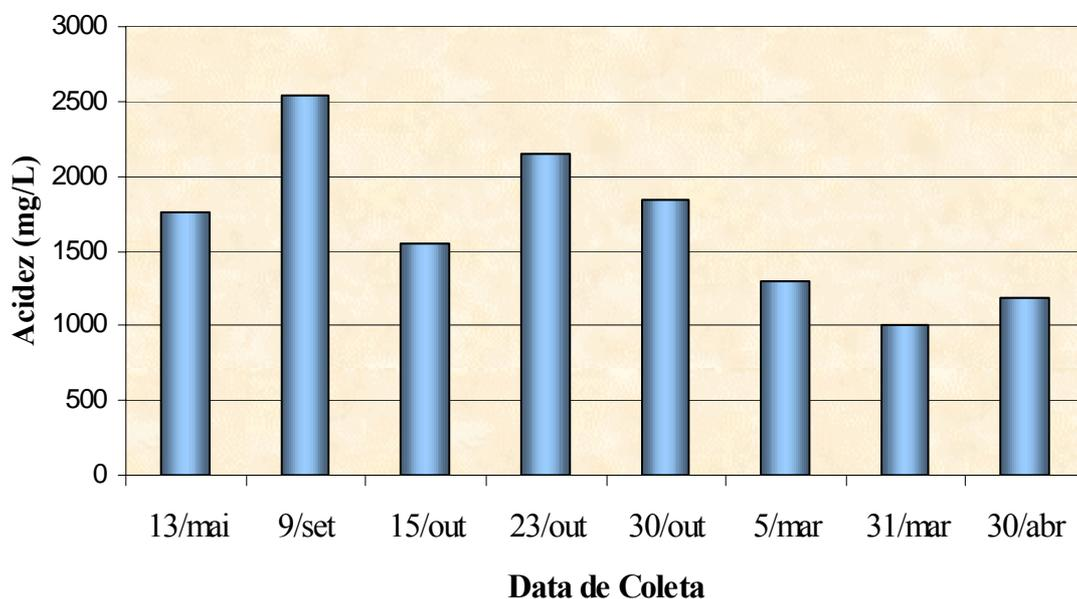
**Figura 4.6:** Variação da Acidez (mg  $\text{CaCO}_3/\text{L}$ ) com a sazonalidade, para as amostras de líquidos percolados coletados no aterro sanitário de Uberlândia – MG, no período de maio/2003 a abril/2004.
