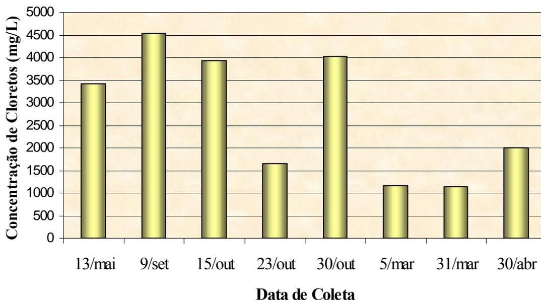
**Figura 4.4:** Variação da Concentração de Cloretos (mg/L) com a sazonalidade, para as amostras de líquidos percolados coletados no aterro sanitário de Uberlândia – MG, no período de maio/2003 a abril/2004.
