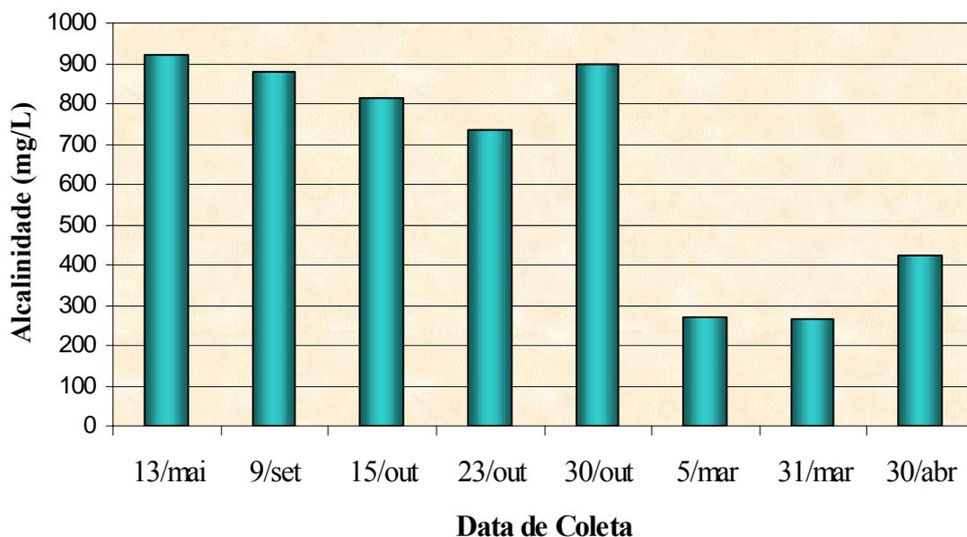
**Figura 4.5:** Variação da Alcalinidade (mg  $\text{CaCO}_3/\text{L}$ ) com a sazonalidade, para as amostras de líquidos percolados coletados no aterro sanitário de Uberlândia – MG, no período de maio/2003 a abril/2004.
