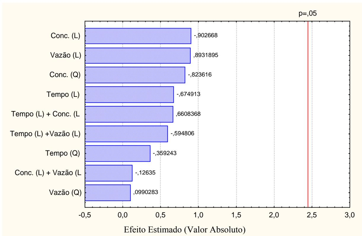
**Figura 4.16:** Diagrama de Pareto para todas as variáveis e suas possíveis interações em relação à remoção da concentração de nitrogênio amoniacal a um nível de significância de 95%, para o 2º planejamento.
