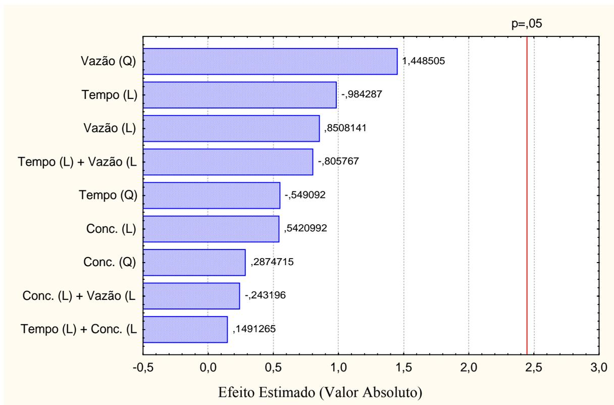
**Figura 4.24:** Diagrama de Pareto para todas as variáveis e suas possíveis interações, em relação à remoção da concentração de nitrogênio amoniacal, a um nível de significância de 95%, para o 4º planejamento.
