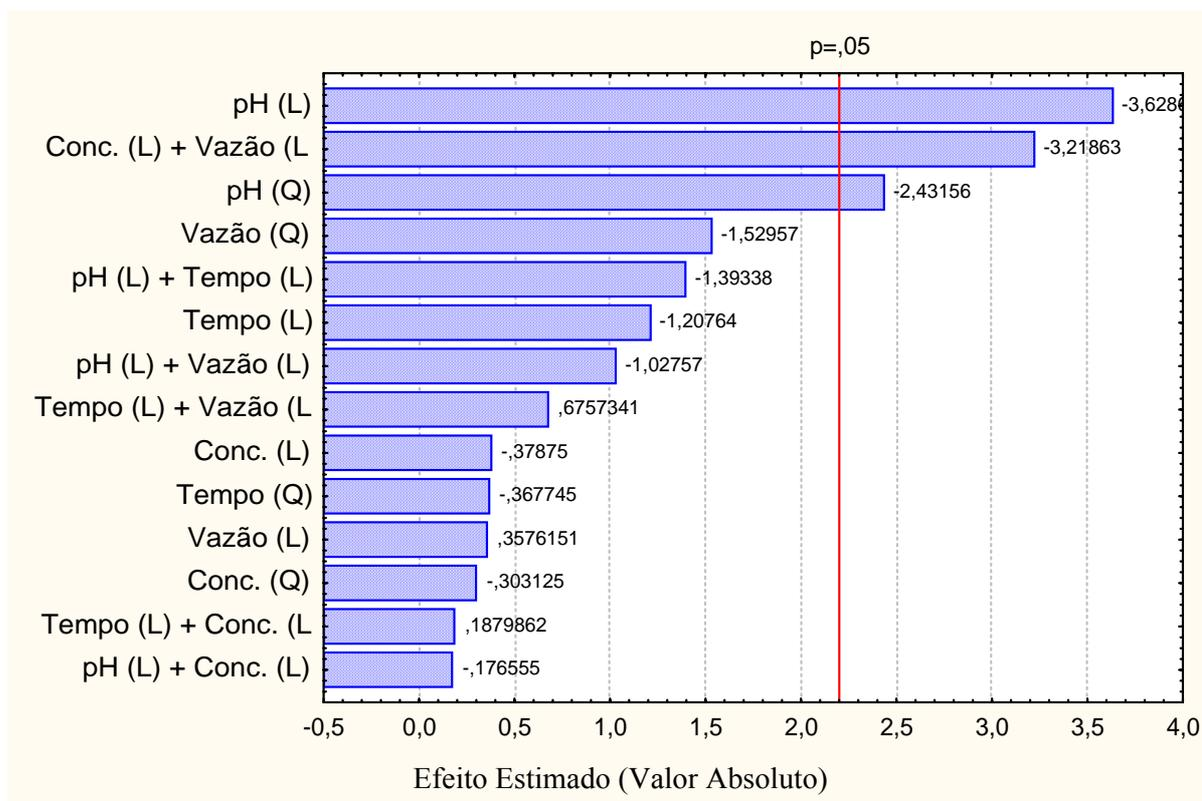
**Figura 4.9:** Diagrama de Pareto para todas as variáveis e suas possíveis interações, em relação à remoção de DQO, a um nível de significância de 95%, para o 1º planejamento.
