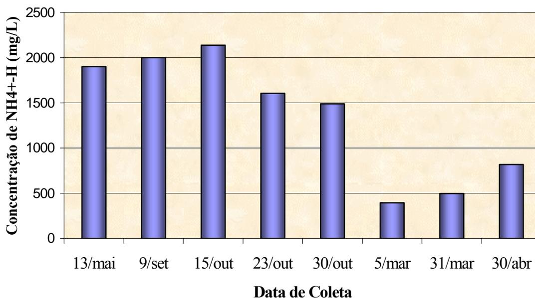
**Figura 4.7:** Variação da Concentração de Nitrogênio Amoniacal (mg/L) com a sazonalidade, para as amostras de líquidos percolados coletados no aterro sanitário de Uberlândia – MG, no período de maio/2003 a abril/2004.
