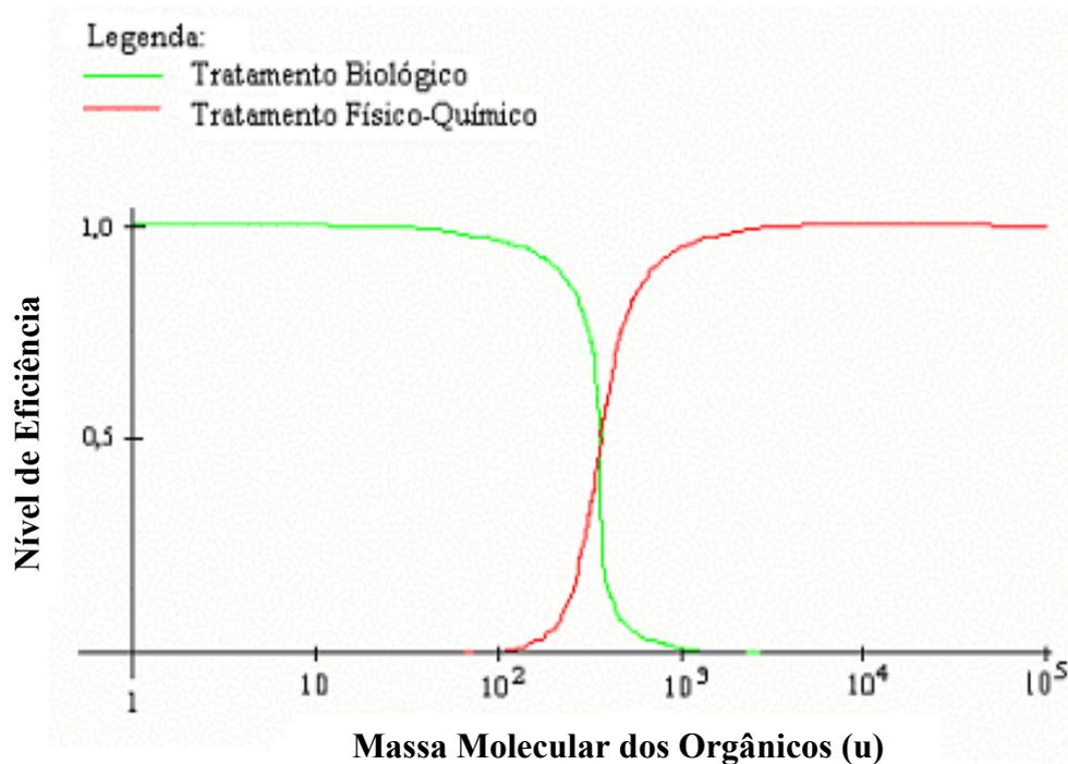
**Figura 2.2** – Nível de eficiência dos tratamentos em função da massa molecular dos orgânicos (u) (FORGIE, 1988c).
