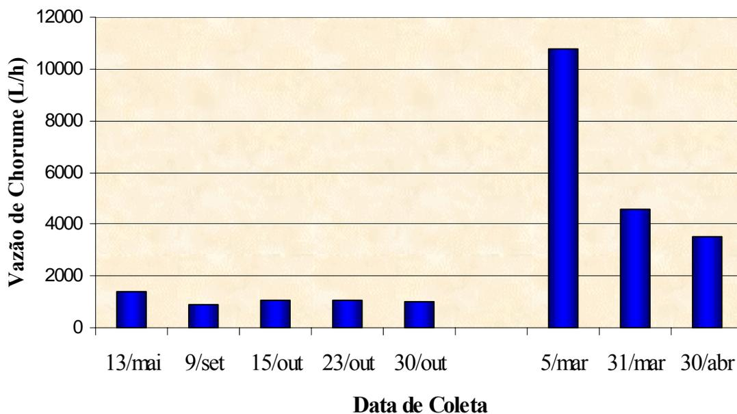
**Figura 4.1:** Variação da Vazão de chorume (L/h) com a sazonalidade, para as amostras de líquidos percolados coletados no aterro sanitário de Uberlândia – MG, no período de maio/2003 a abril/2004.
