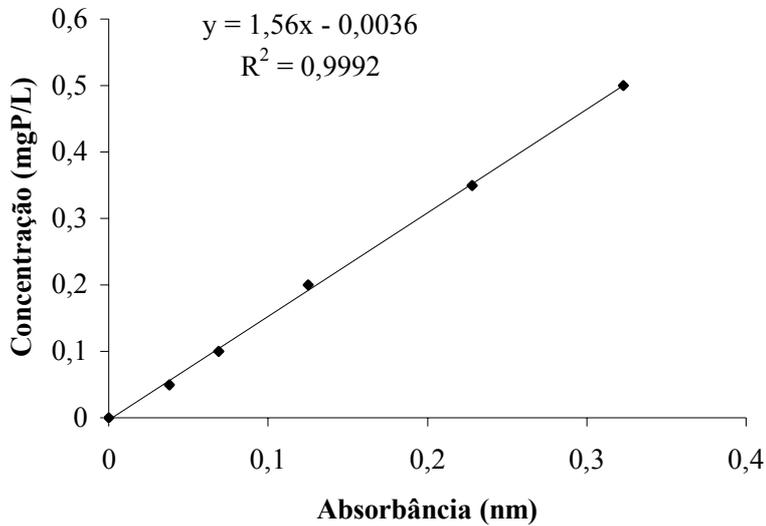
**Figura A6** – Curva de calibração para determinação de Fósforo Total.
