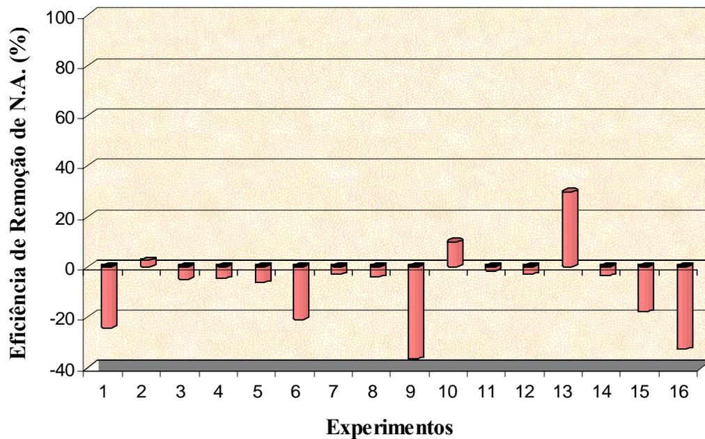
**Figura 4.22:** Eficiência de remoção de nitrogênio amoniacal (%) para os experimentos realizados no 4º planejamento experimental.
