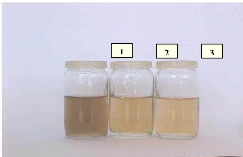
Figura 4.28: Fotografia dos líquidos percolados e tratados utilizados nos testes com clarificação como pré-tratamento, (1) Chorume Bruto, (2) Clarificado e Fotocatalisado (Exp. 60) e (3) Clarificado e Fotocatalisado (Exp. 61).
