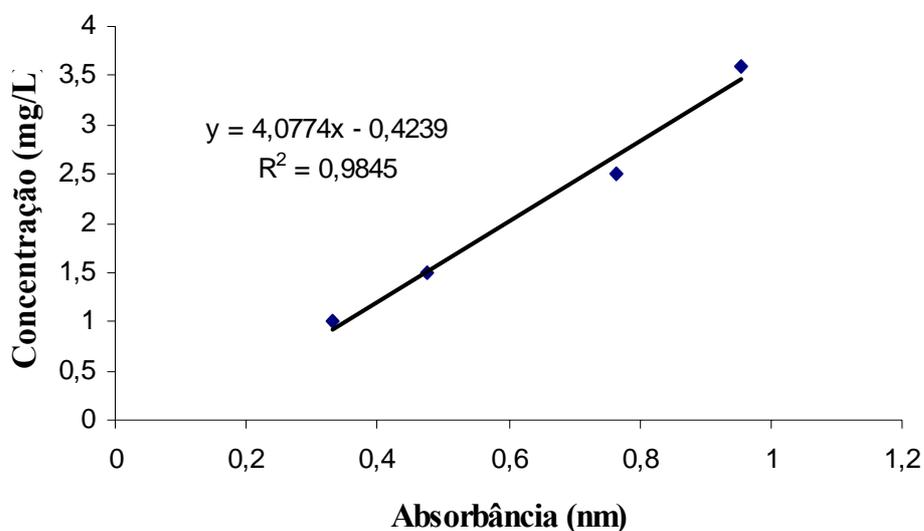
**Figura A10.1** – Curva de calibração para determinação de manganês.
