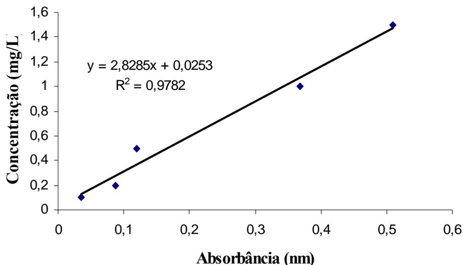
**Figura A10.5** – Curva de calibração para determinação de zinco.
