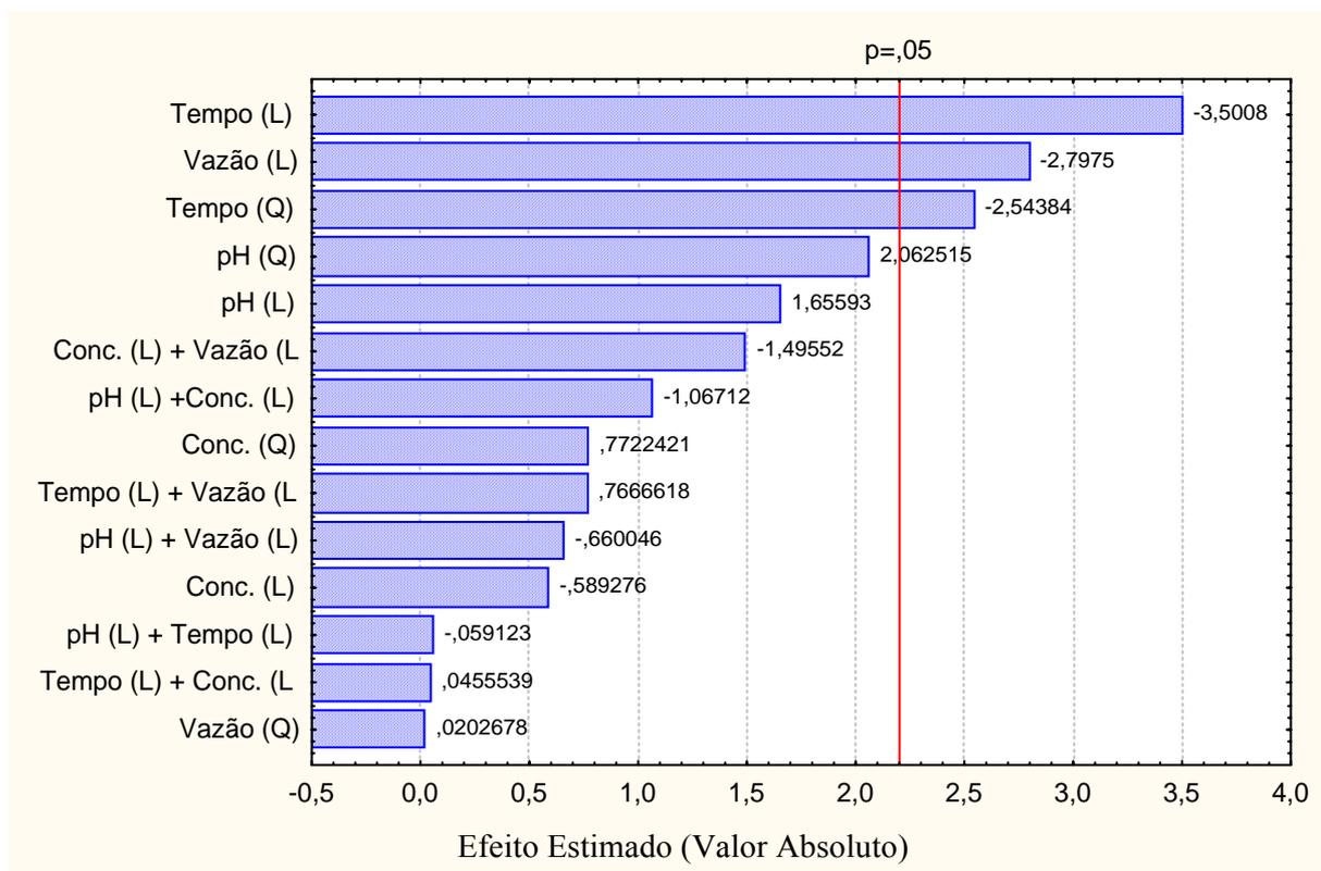
**Figura 4.12:** Diagrama de Pareto para todas as variáveis e suas possíveis interações, em relação à remoção percentual da concentração de nitrogênio amoniacal, a um nível de significância de 95%, para o 1º planejamento experimental.
