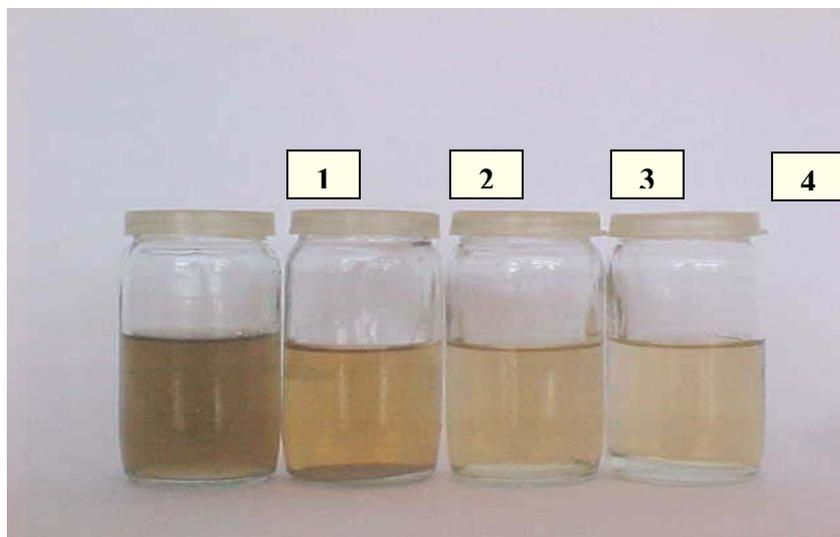
**Figura 4.30:** Fotografia dos líquidos percolados e tratados utilizados nos testes com floclação como pré-tratamento, (1) Chorume Bruto, (2) Floclado, (3) Floclado e Fotocatalisado (Exp. 60) e (4) Floclado e Fotocatalisado (Exp. 61).
