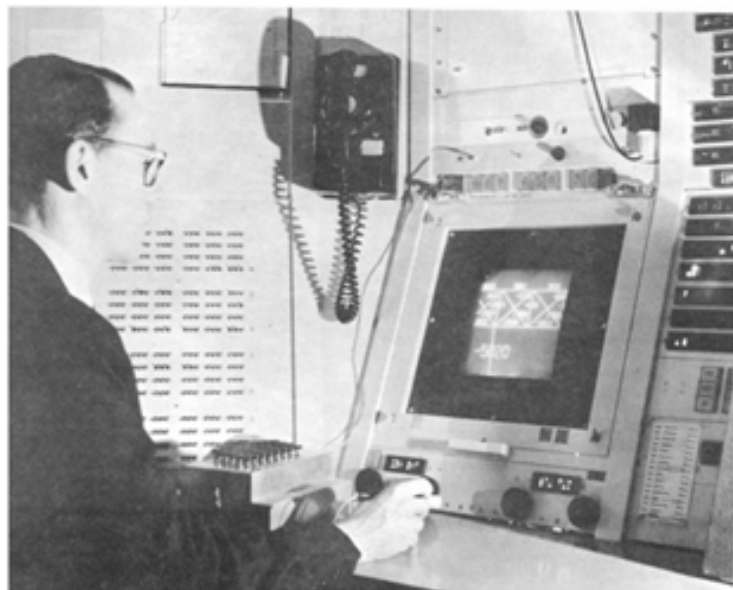
Figura 25. Ivan Sutherland utilizando o Sketchpad por meio da caneta luminosa para desenhar a estrutura de uma ponte (SUTHERLAND, 1963, p.20).
