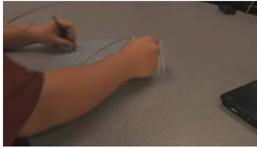
Figura 60. Sistema multi-touch , manipulação de um display interativo com duas canetas infravermelho. Extraído do vídeo: Low-Cost Multi-touch Whiteboard using the Wiimote , 2007.
