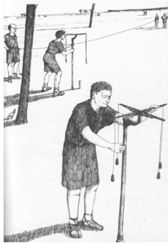
Figura 18. Agrimensores romanos em seu trabalho com as gromas. Extraído de Borges Filho, 2005 p. 233, original de Macaulay, David. Op.cit., 1989, p.17.
