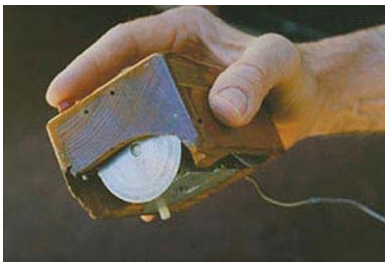
Figura 29. Modelo original do mouse criado em 1968, contando com apenas um botão e corpo de madeira. Disponível em: http://www.granneman.com/techinfo/background/history/ , acesso 20/09/2008.
