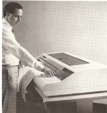
Figura 34. Scanners óticos assumem as mesmas funções do digitalizador, mas trabalham de forma automática (KENNEDY, 1986 p. 18).
