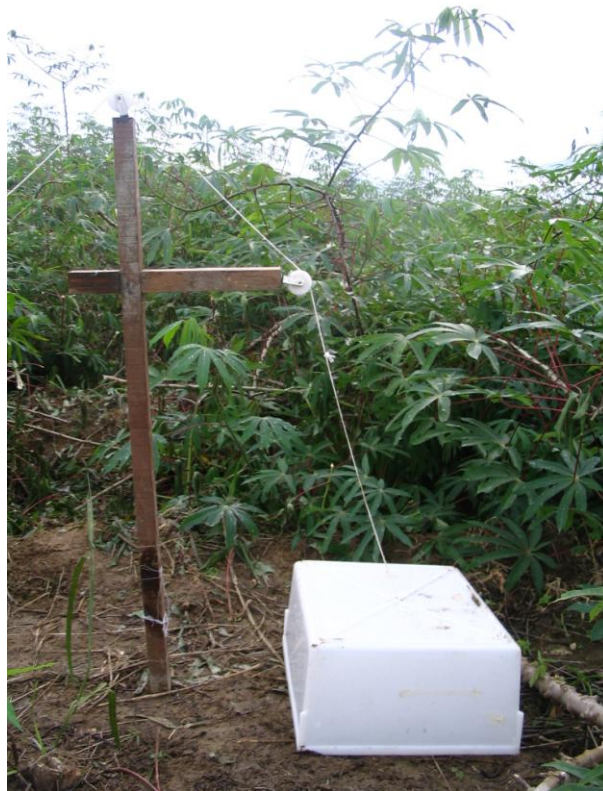
Figura 2.5. Mecanismo de soltura dos marsupiais, composto por uma estaca de madeira, uma gaiola plástica, roldanas e corda. O mecanismo permite soltar os indivíduos à distância, minimizando a influência do pesquisador sobre os movimentos dos animais.
