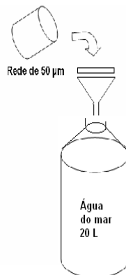
Figura 08: Desenho esquemático da filtração da água do mar realizada em campo para posteriormente ser transportada ao laboratório.
