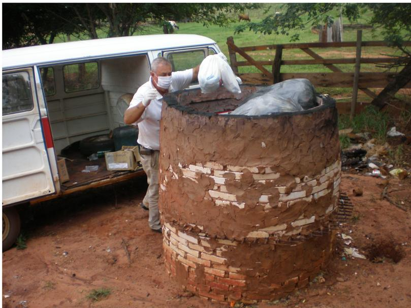
Figura 5.43 - Resíduos infectantes sendo colocados no segundo forno de queima, pelo funcionário da FUNASA.
