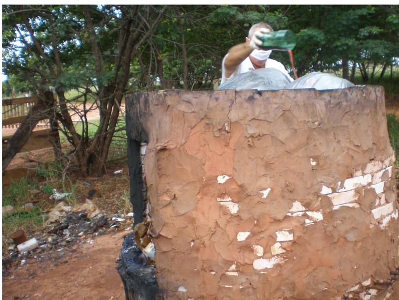
Figura 5.44 – Combustível sendo adicionado ao forno de queima 2.
