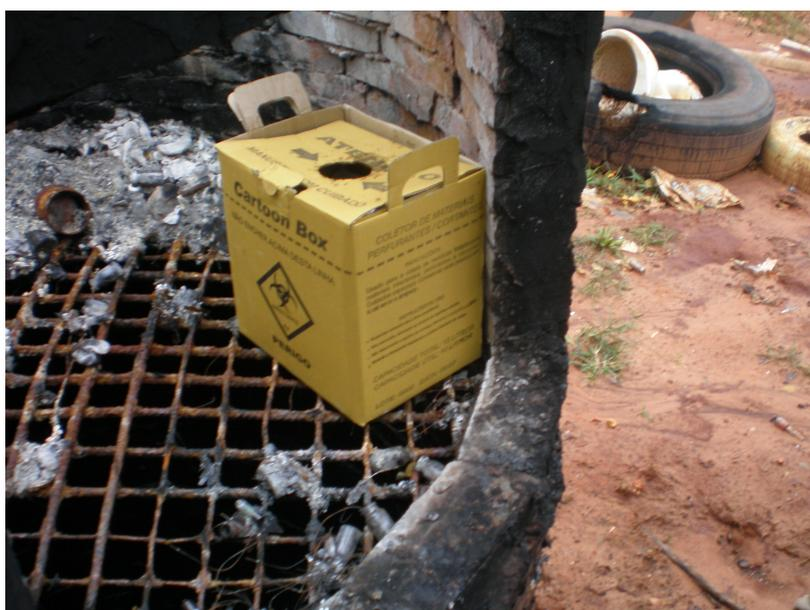
Figura 5.42 – Caixa de descarte de perfurocortante sendo colocada no forno de queima 1.
