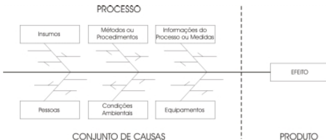
FIGURA 3.13 - Caracterização de um processo por meio do diagrama de causa e efeito (WERKEMA, 1995).
