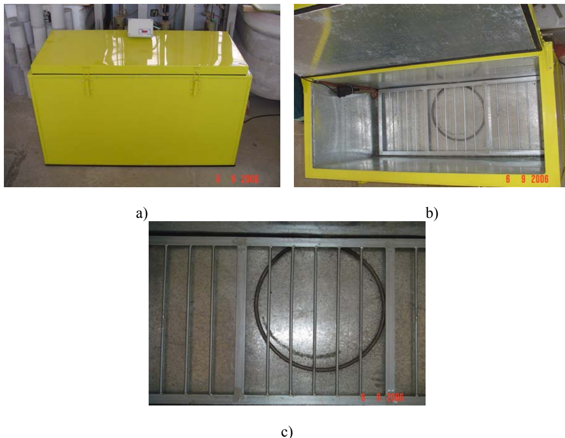
Figura 27: tanque para ser utilizado com temperatura de 30°C a) vista geral; b) detalhe da parte interna; c) detalhe da resistência
