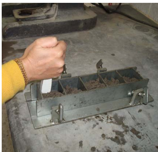
Figura 39: adensamento do corpo-de-prova 50x50x50mm
