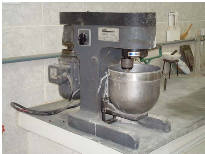
Figura 38: argamassadeira utilizada para produção das argamassas
