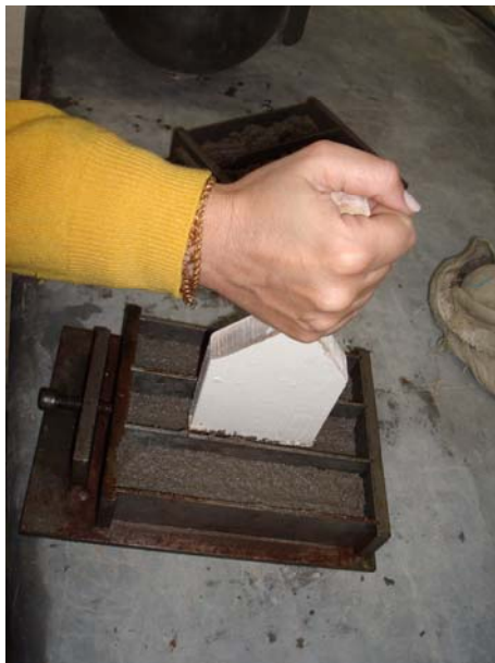
Figura 40: adensamento do corpo-de-prova 40x40x160mm
