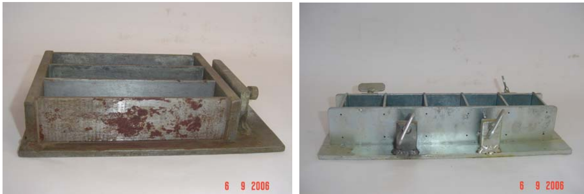
Figura 22: fôrmas para argamassa utilizadas no ensaio de maturidade a) 40x40x160mm; b) 50x50x50mm
