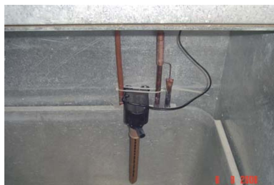
Figura 26: detalhes do tanque de temperatura de 10°C a) vista interna; b) detalhe do agitador de água
