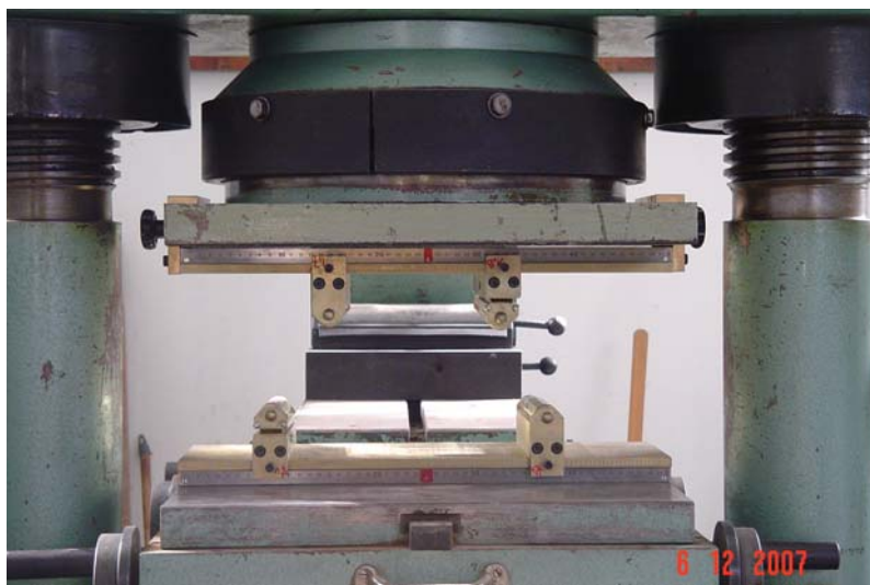
Figura 21: dispositivo para o ensaio de resistência à tração na flexão acoplado na prensa
