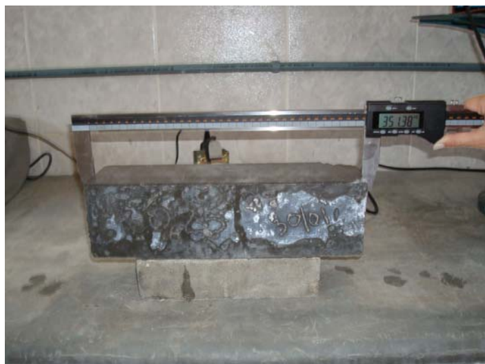
Figura 35: medição do corpo-de-prova com paquímetro
