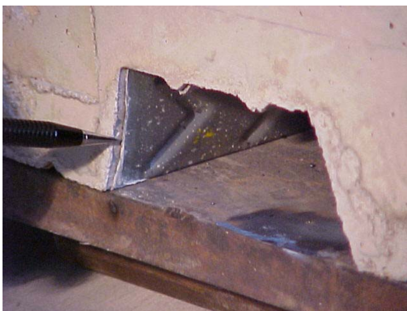
FIGURA 3.4 - Detalhe do deslocamento horizontal relativo entre a fôrma de aço e o concreto (end-slip)
