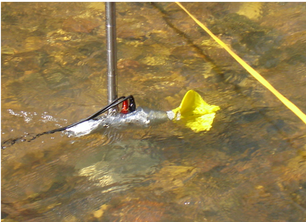
Figura 7. Molinete hidrométrico utilizado para a medição de vazão do Rio do Peixe, próximo à foz.
