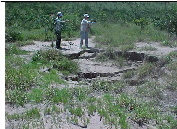
Figura 16. Início do fenômeno de *piping* próximo a voçoroca existente no vale do córrego Panela, em Serranópolis/GO.
