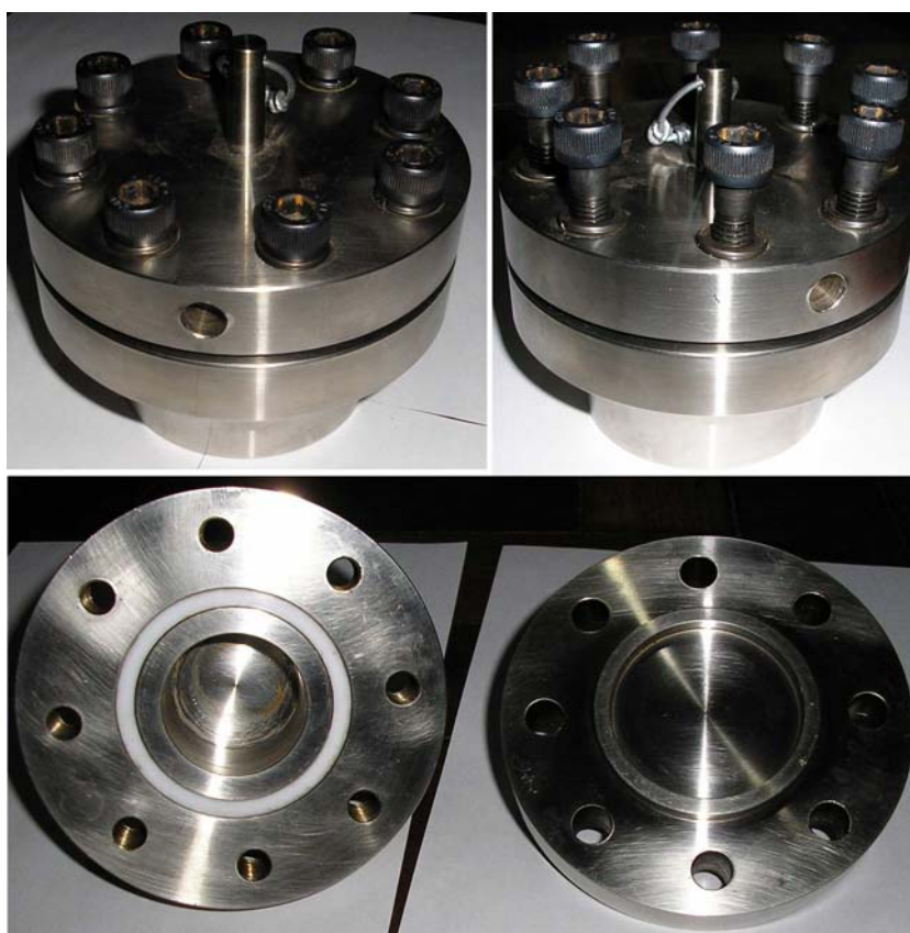
Figura 39 Reator utilizado para a síntese hidrotérmica do [\text{Cu}_2(\mu\text{-obb})_2(\mu\text{-bpe})]_n .
