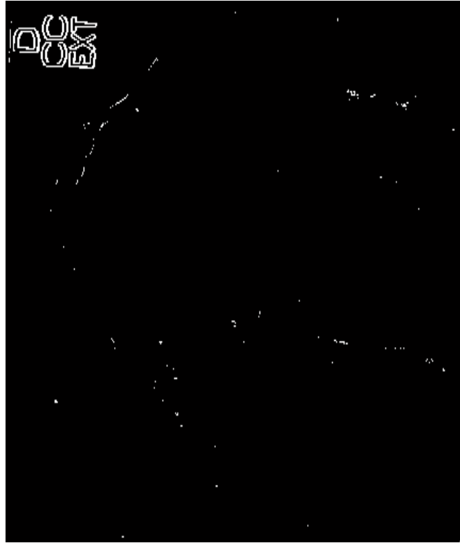
Figura 5.2. Imagem da figura 4.10 (b) pré-processada pela associação do filtro diferencial (eq. 5.1) com o filtro de Sobel (eq. 5.2).
