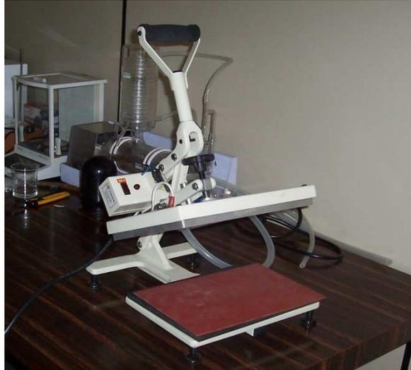
Figura 3.7. Prensa térmica utilizada para transferir a camada protetora ao FTO na fabricação dos substratos interdigitados.
