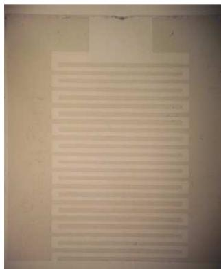
Figura 3.8. Fotografia de um substrato de vidro coberto com FTO modelado no padrão de interdigitado, obtida através da lente ocular de um microscópio óptico. As trilhas estão espaçadas de 300  $\mu\text{m}$ .
