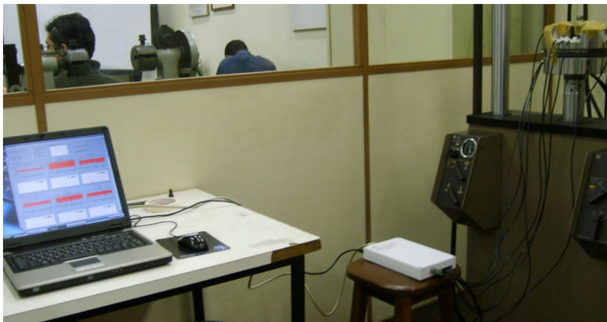
Figura 62 - Acelerômetros acoplados ao sistema mecânico para calibração dinâmica.
