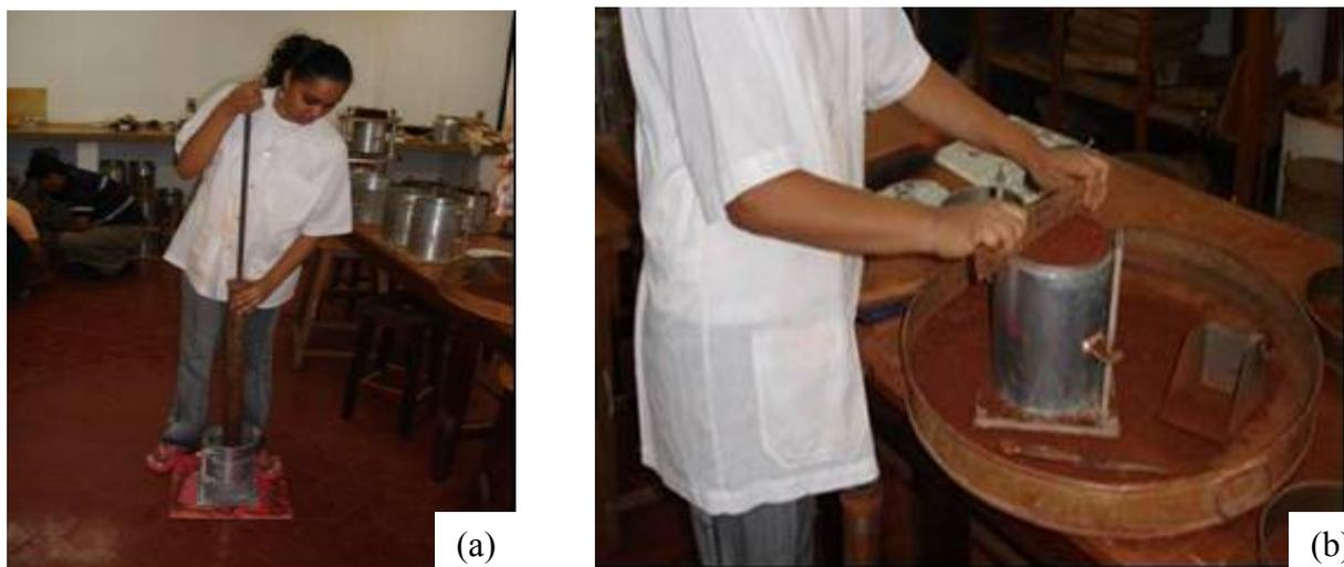
**Figura 4.11** Realização do ensaio de Compactação: (a) Ensaio de compactação com as amostras; (b) Ensaio de compactação com o solo do CEASA
