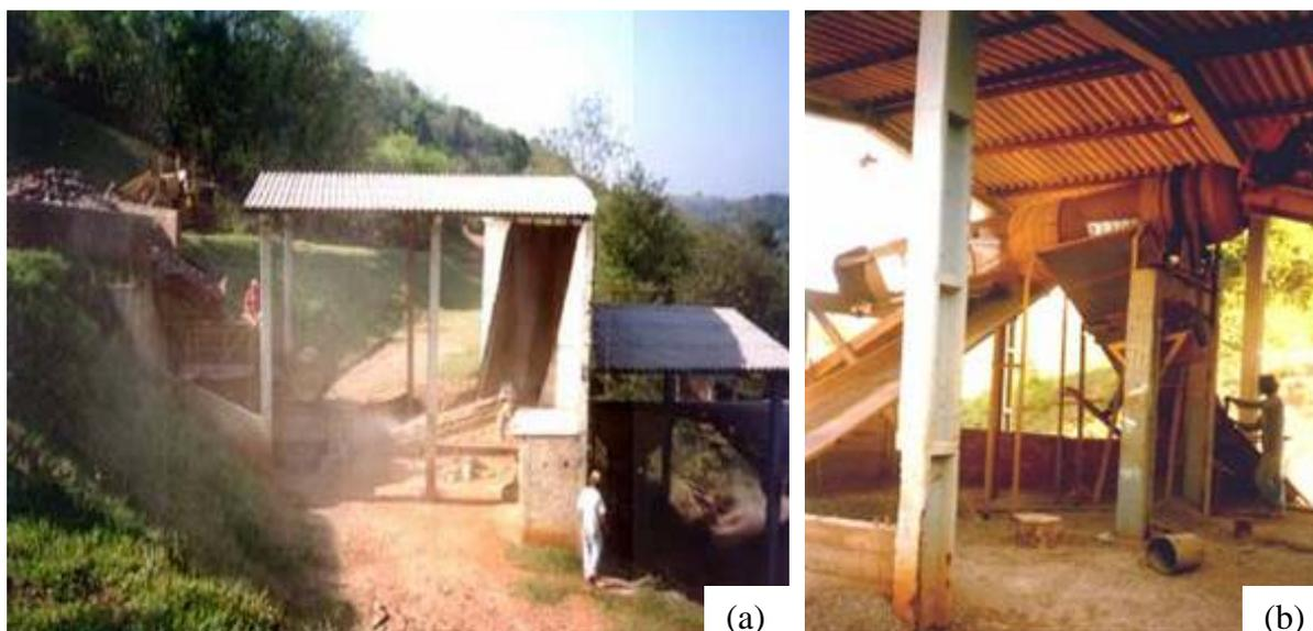
**Figura 2.5** Usina de Reciclagem de Londrina (PR): (a) Vista geral da usina com dois britadores dispostos em série; (b) Peneiras rotativas (LATTERZA, 1998)
