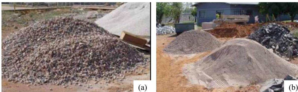
**Figura 4.5** Separação do material: (a) Brita 38mm; (b) Brita 19mm (à esquerda) e brita 4,8mm (à direita) (SILVA, 2004)
