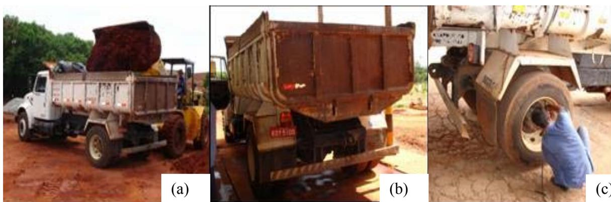
**Figura 4.26** Preparação do caminhão para os ensaios: (a) Carregamento do solo; (b) Verificação do peso na roda traseira; (c) Aferição dos pneus
