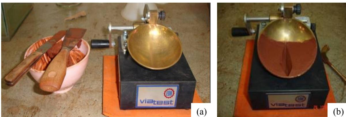
**Figura 4.9** Determinação do limite de liquidez: (a) Aparelho de Casagrande; (b) Realização do ensaio
