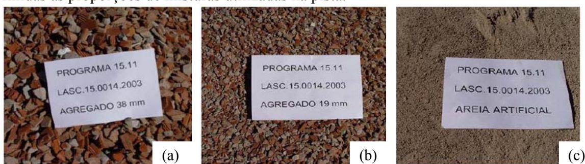
**Figura 4.19** Granulometrias estudadas para o RCC: (a) brita de 19 mm; (b) brita de 9,5 mm; (c) areia artificial (SILVA, 2004)
