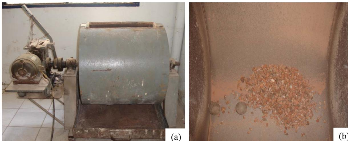
**Figura 4.16** Execução do Ensaio de Abrasão *Los Angeles*: (a) Vista frontal do Equipamento; (b) Vista interna.
