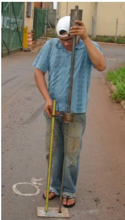
**Figura 4.29** Realização do ensaio de DCP no trecho do CEASA
