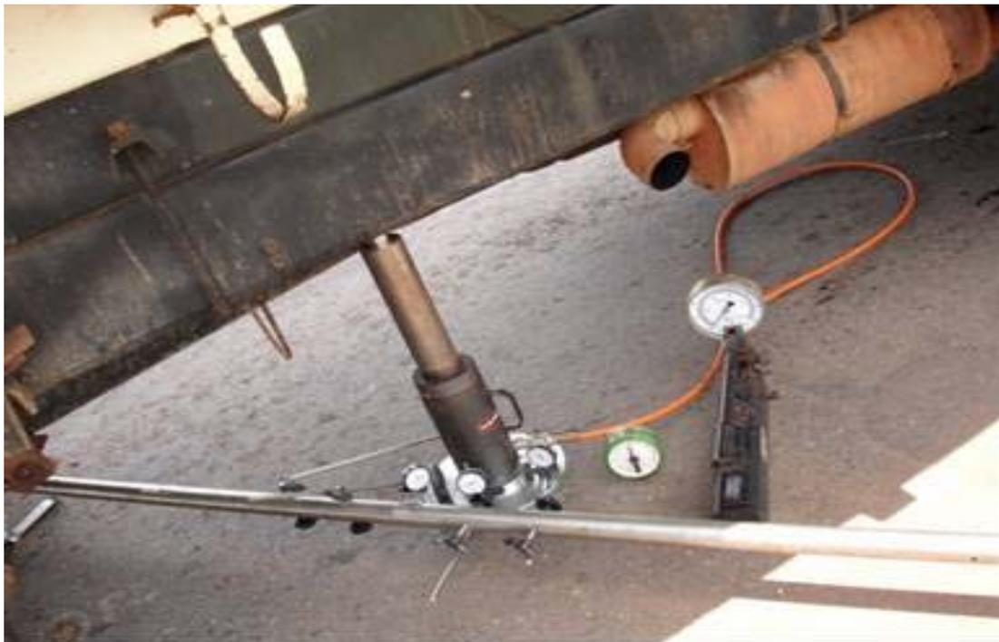
**Figura 3.4** Equipamento utilizado para o ensaio de Prova de Carga
