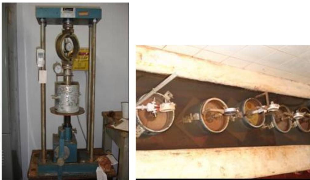
**Figura 4.12** Realização dos ensaios de CBR e expansão: (a) Ensaio de *California Bearing Ratio* (CBR); (b) Ensaio de expansão
