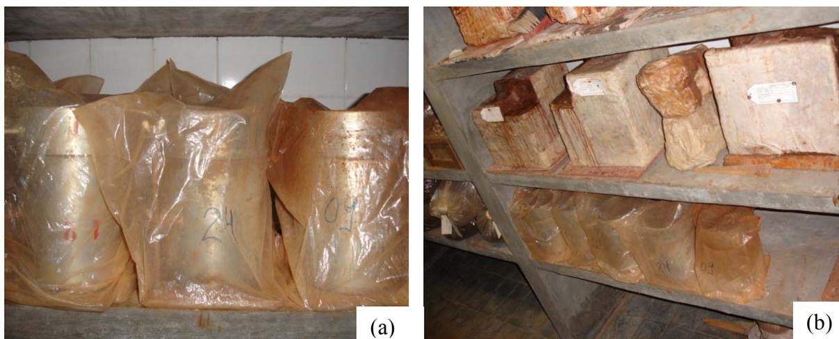
**Figura 4.14** Cura dos corpos-de-prova: (a) Os corpos-de-prova na câmara úmida; (b) Vista geral da câmara úmida
