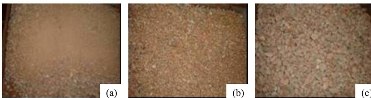
**Figura 4.6** Detalhe do material estudado: (a) brita de 4,8mm; (b) brita de 19mm; (c) brita de 9,5mm
