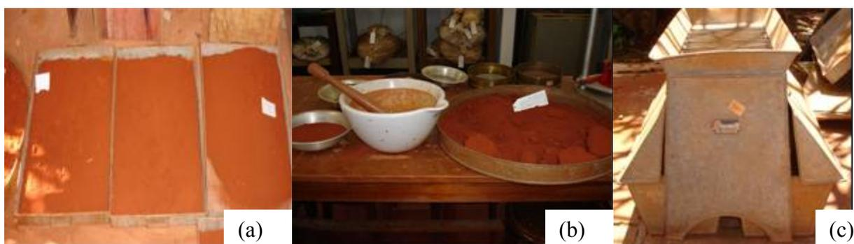
**Figura 4.3** Preparação do solo: (a) Secagem; (b) Desmanche dos torrões; (c) Quarteamento
