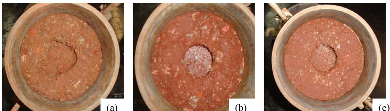
**Figura 4.15** Amostras depois da realização do ensaio de CBR: (a) Amostra L1; (b) Amostra L2; (c) Amostra L3
