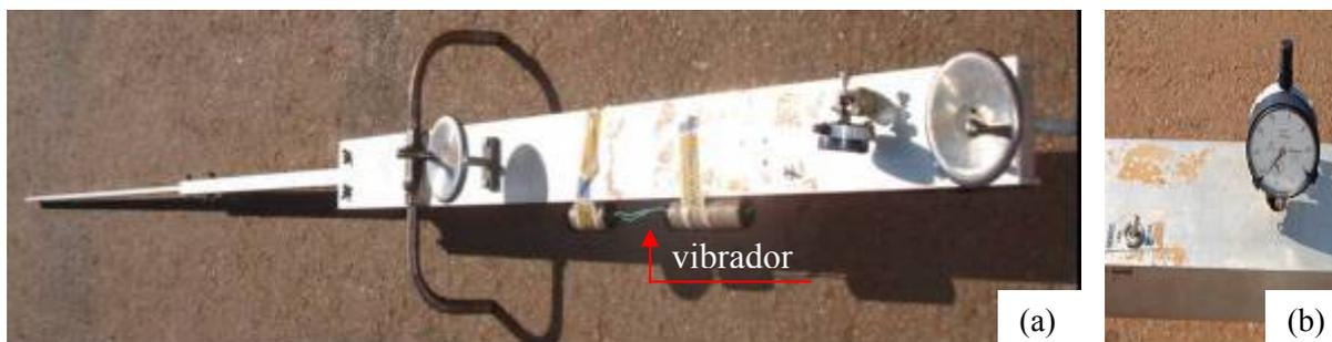
**Figura 4.27** Ensaio de viga Benkelman: (a) Detalhe da viga; (b) Detalhe do extensômetro
