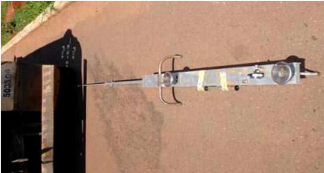
**Figura 3.3** Equipamento utilizado para o ensaio de viga Benkelman
