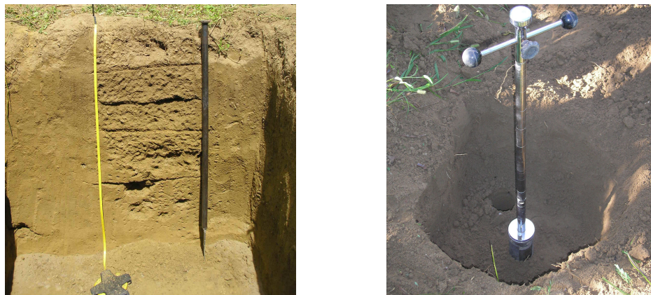
Figura 1. Detalhamento do perfil do solo (a) e do equipamento utilizado para coleta de amostras indeformadas (b).
