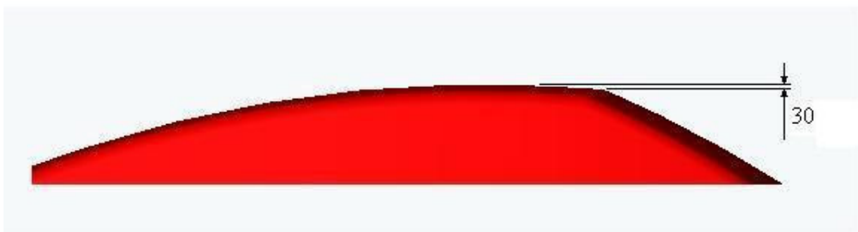
Figura 4.32: Curvatura do teto na primeira versão.
