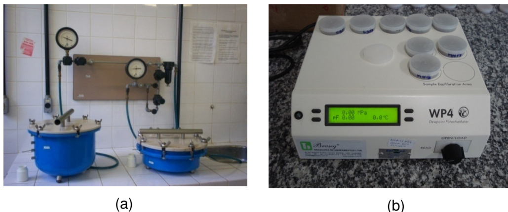
Figura 1: Equipamentos utilizados para elaboração da curva de retenção de água no solo para a camada superficial do solo (0 – 0,2 m) sob dois sistemas de uso e manejo: a) Câmara de pressão de Richards e b) psicrômetro WP4.
