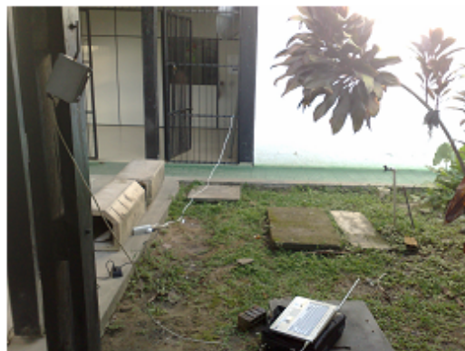
Figura C.2: As etiquetas de RFID e o leitor de RFID fixo na pilastra
