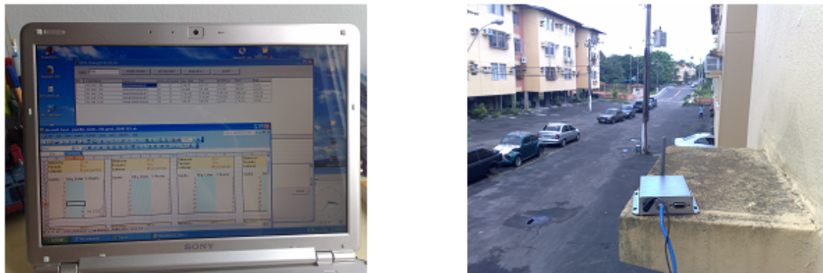
Figura C.5: Software para coleta dos dados e o leitor de RFID sob a saída do ar-condicionado
