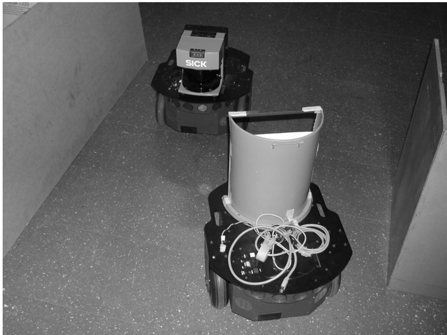
Figura 72: Robôs móveis utilizados nos experimentos de controle de formação líder-seguidor. Fonte: (BRANDÃO, 2008).
