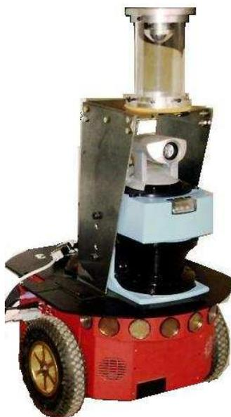
Figura 42: Robô Pioneer 3-DX com sensor de varredura *laser* e sistema de visão omnidirecional.
